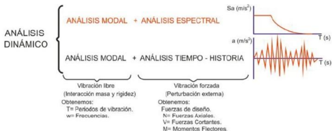
Figura 11. . Esquema Conceptual de del Análisis Dinámico.
