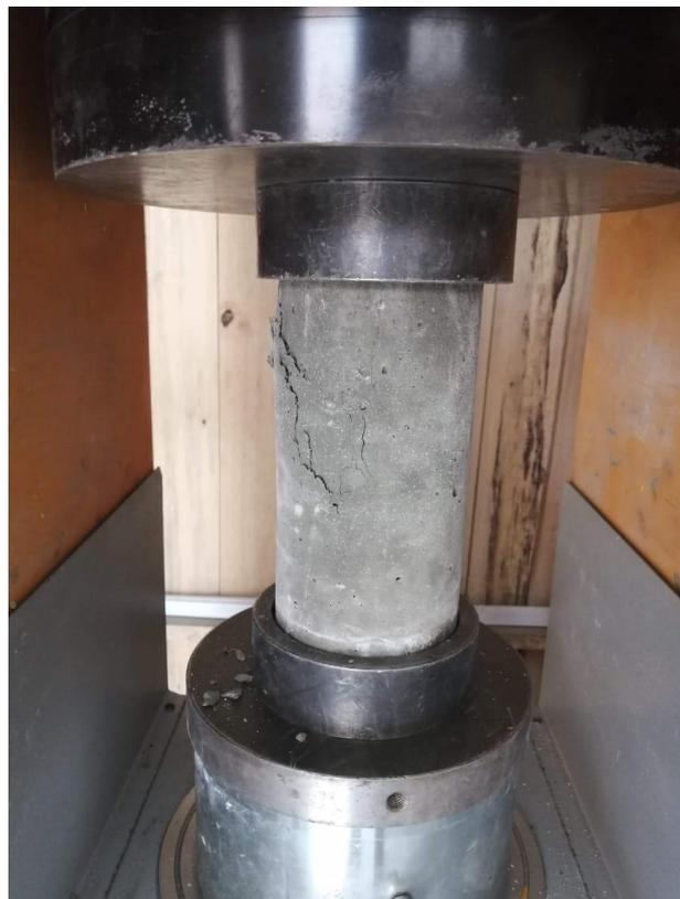
Figura 31: Ensayo de Resistencia a la compresión a 28 días de curado; probeta CP210.
