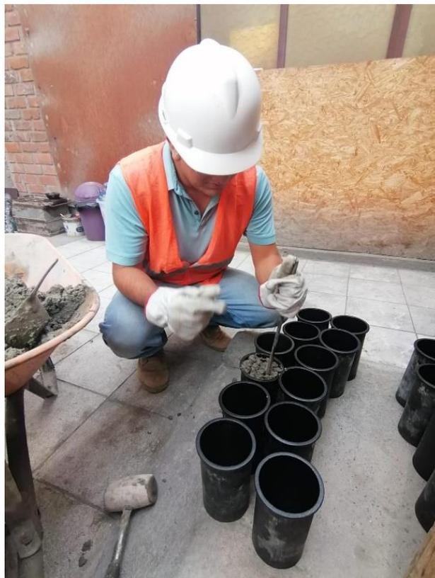
*Figura 25: Elaboración de probetas.*
