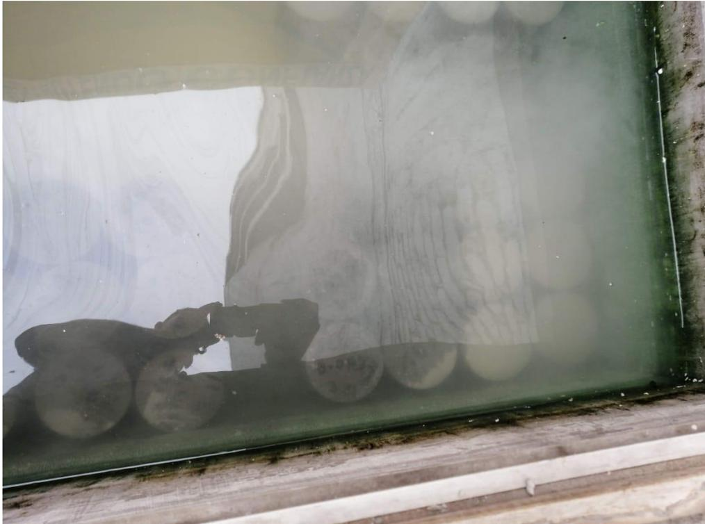
Figura 26: Curado de probetas.
