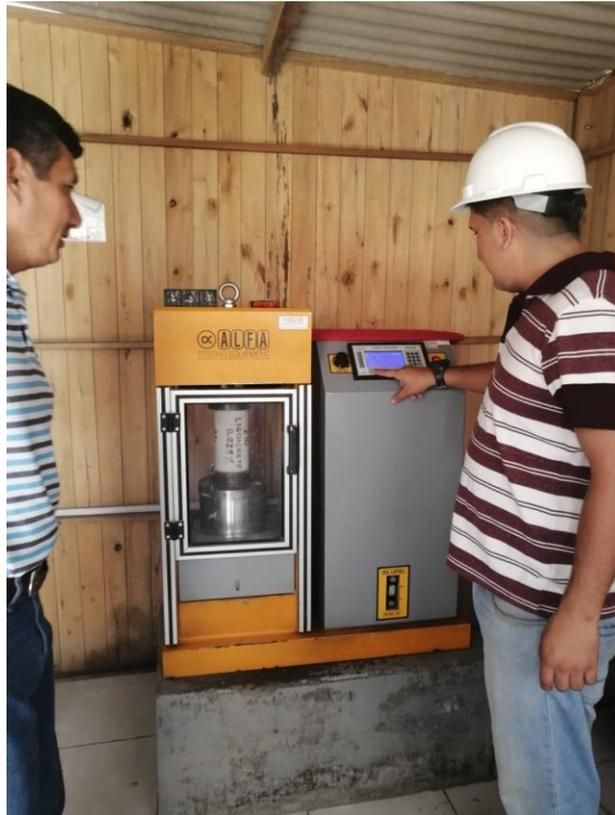
*Figura 32: Ensayo de Resistencia a la compresión a 28 días de curado; probeta C210 + 0.025SL.*
