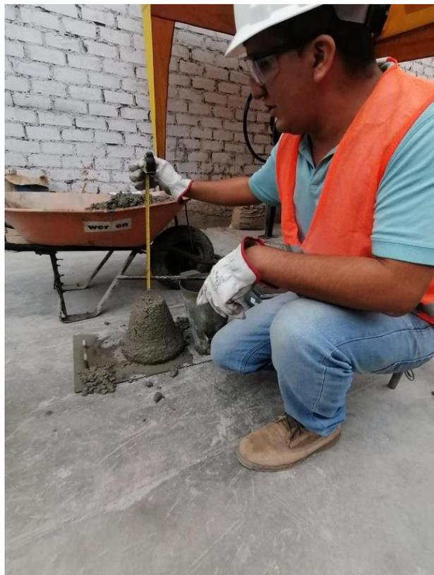
*Figura 23: Medición del asentamiento.*
