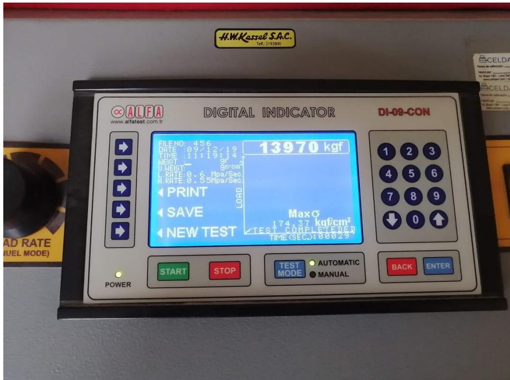
Figura 28: Resistencia alcanzada a los 7 días de curado por probeta C210 +0.05%SL.
