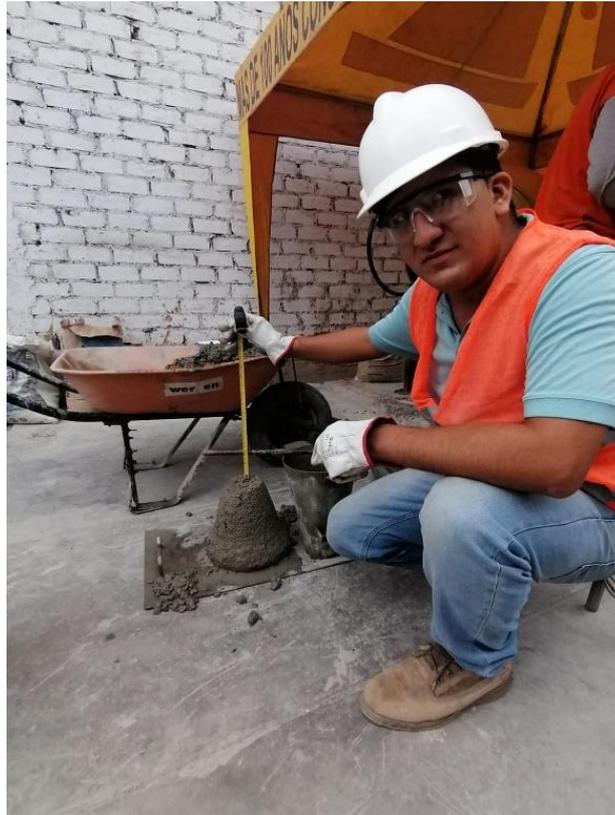
*Figura 22: Asentamiento del concreto en estado fresco.*
