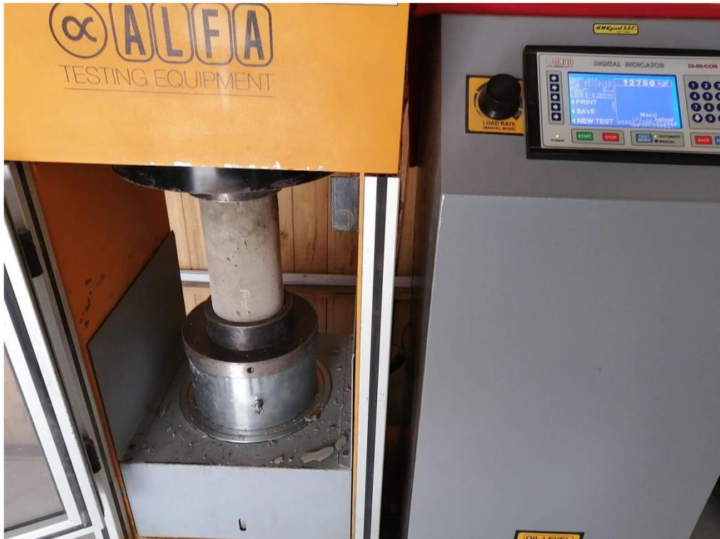
Figura 30: Probeta ensayada a Resistencia a la compresión 7 días de curado; probeta C210 +0.05%SL.
