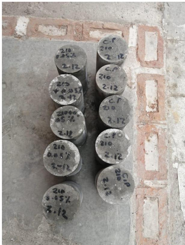
Figura 27: Probetas por ensayar después de 7 días de curado.
