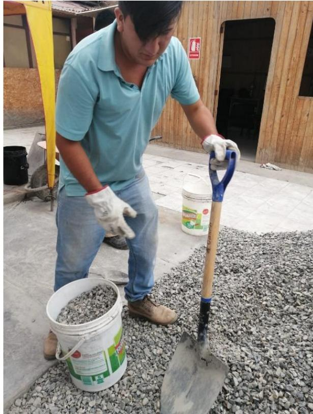
*Figura 20: Medición según diseño del agregado grueso.*
