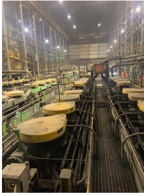
Figura 8: Maquina del área de flotación de minerales
