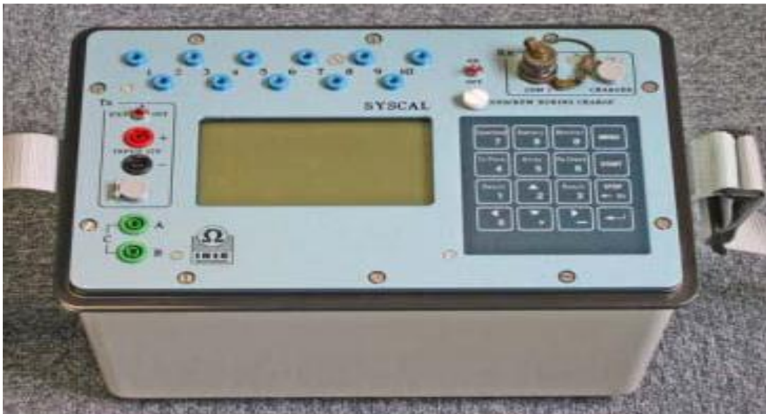
Foto 1: Resistivímetro SYSCAL Pro empleado para la ejecución de los ensayos SEV.
