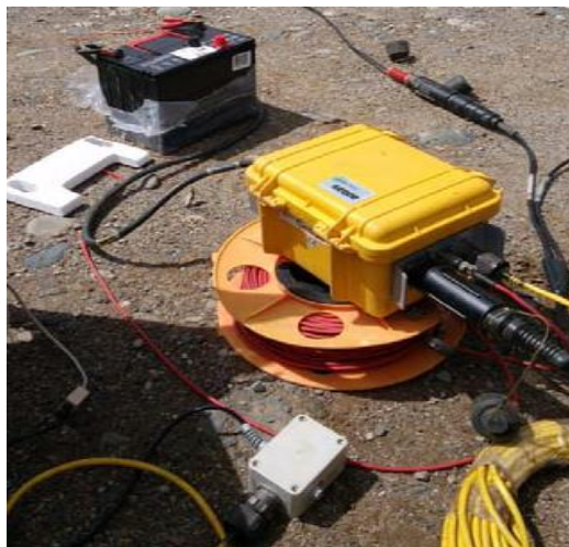
Foto 2: Adquisidor de datos sísmicos compuesto por el sismógrafo GEODE.
