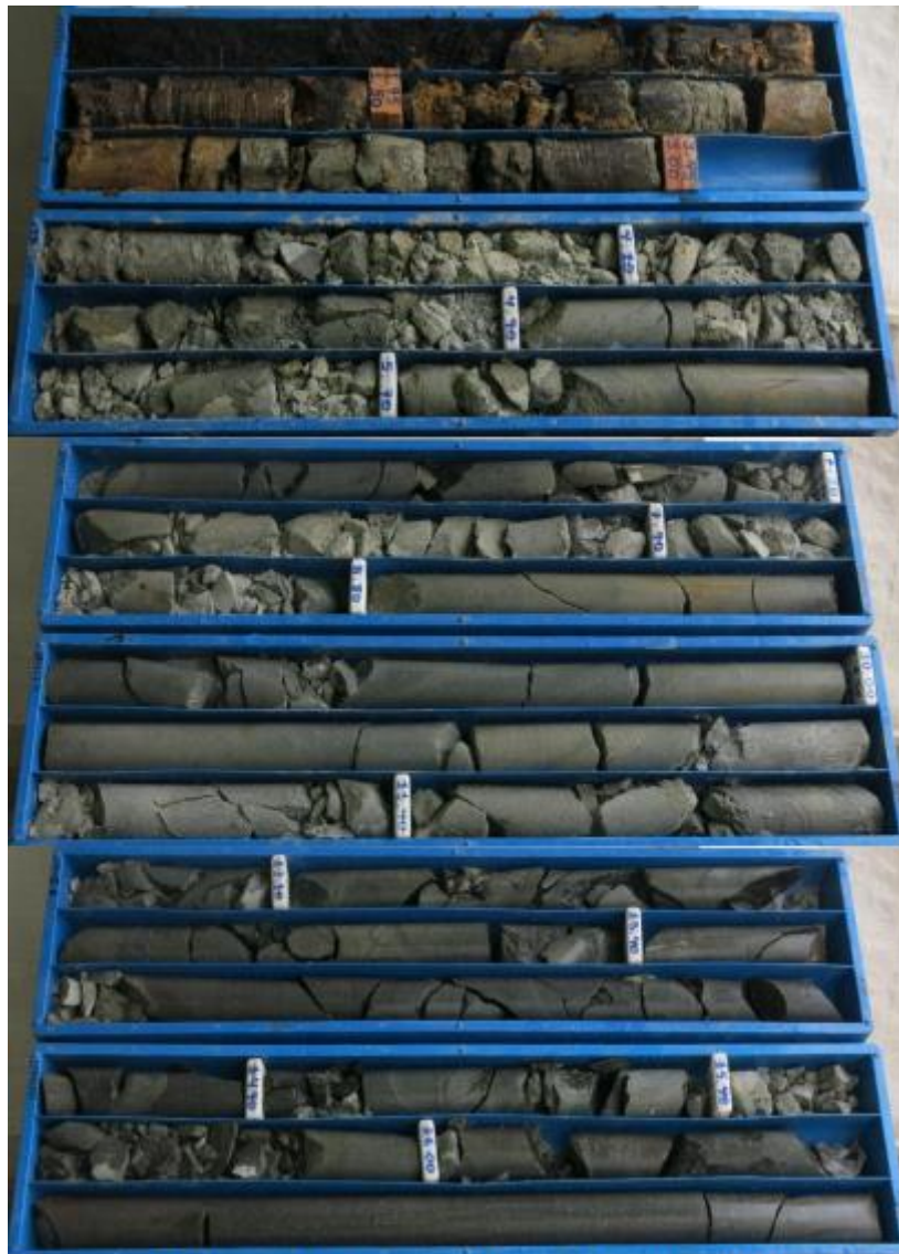
Perforación geotécnica DH-14-101, caja con muestras de 0,00 a 17,50 m.
