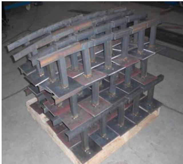
*Figura 15 – Planchas de anclajes para estructuras metálicas*
