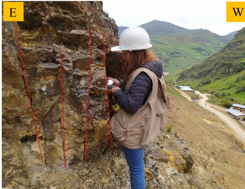
Figura 8: Discontinuidades semiparalelas a la cara del talud.
