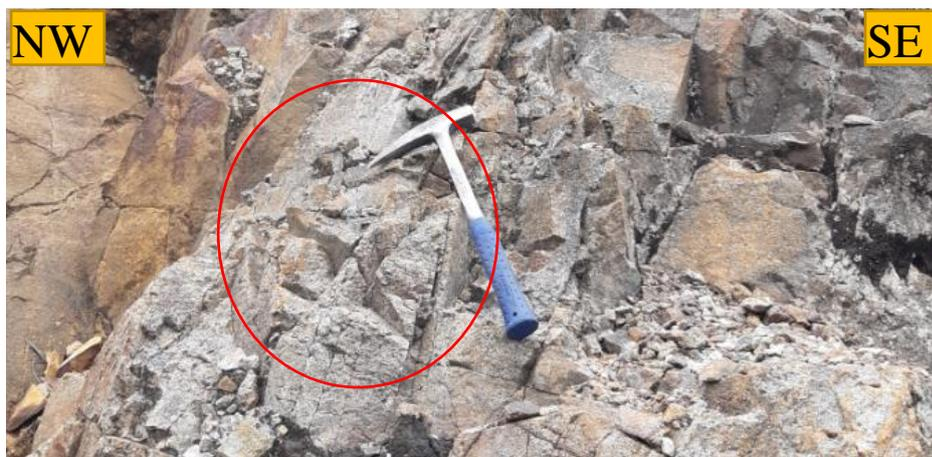
*Figura 41: resistencia a la compresión en campo.*
