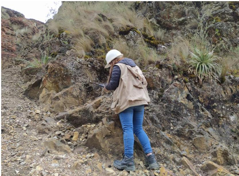
*Figura 58. Medición de persistencia de la discontinuidad.*
