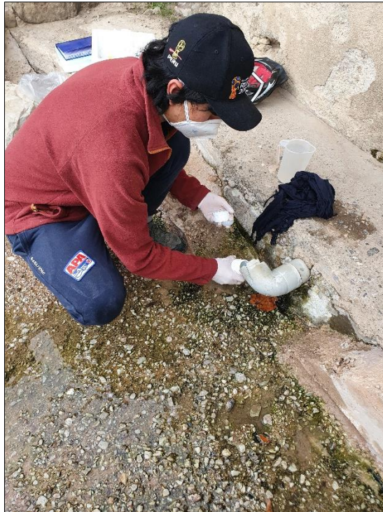
Figura. 8. Contaminación de frasco con agua del punto de muestreo.
