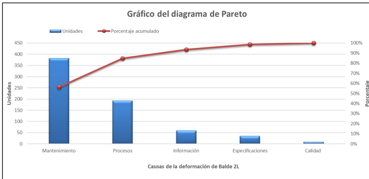
Figura 24 Gráfico de Diagrama de Pareto de las Causas de la Deformación de los Baldes 2L
