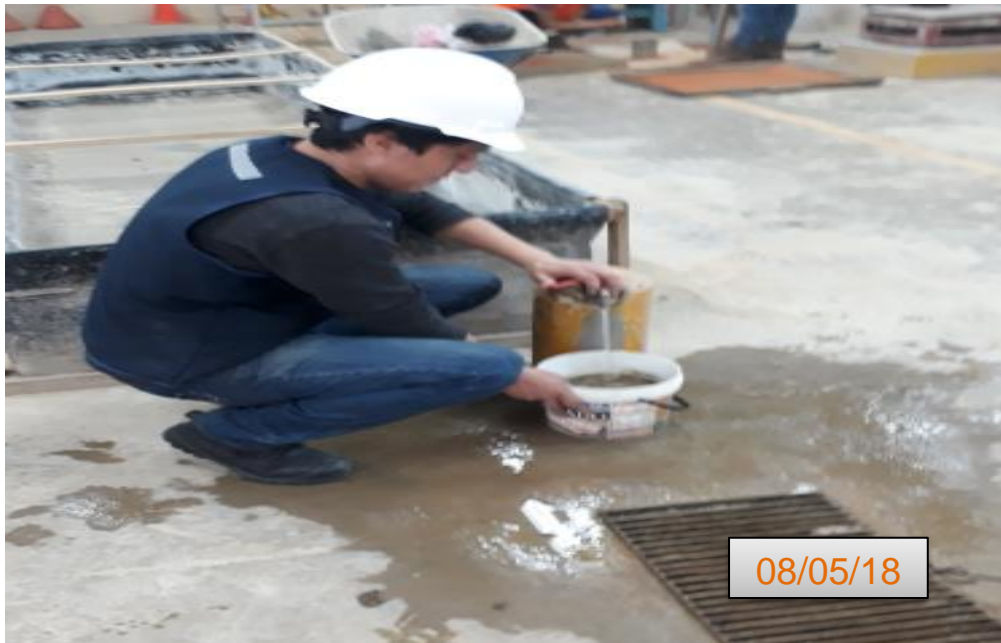
Fotografía 9 Lavado de agregado para ensayo que pasa por tamiz #200.
