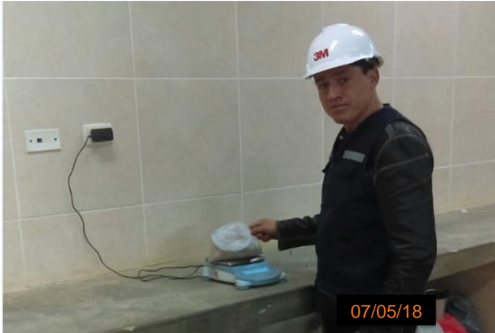
Fotografía 3 Peso de material húmedo para ensayo de contenido de humedad.
