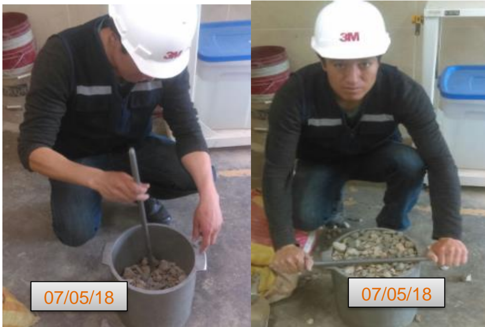
Fotografía 7 Ensayo Peso Unitario Compactado del agregado grueso.
