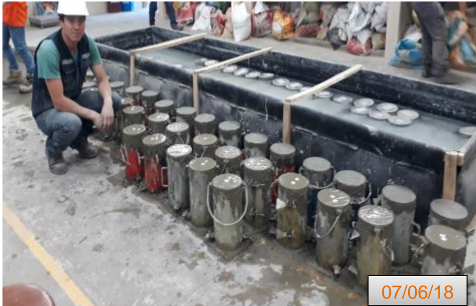
Fotografía 19 Elaboración de probetas cilíndricas.
