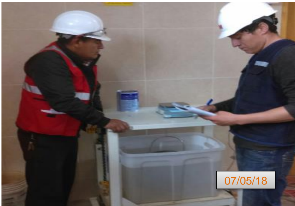
Fotografía 10 Peso sumergido de la canastilla y el agregado.
