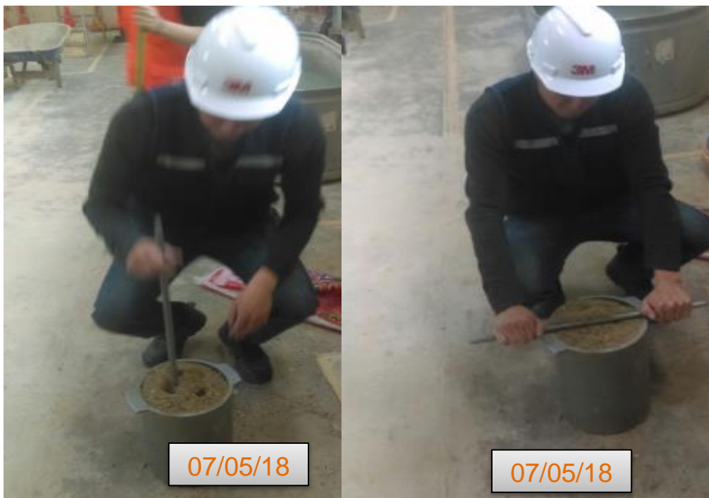
Fotografía 8 Ensayo Peso Unitario Compactado del agregado grueso.
