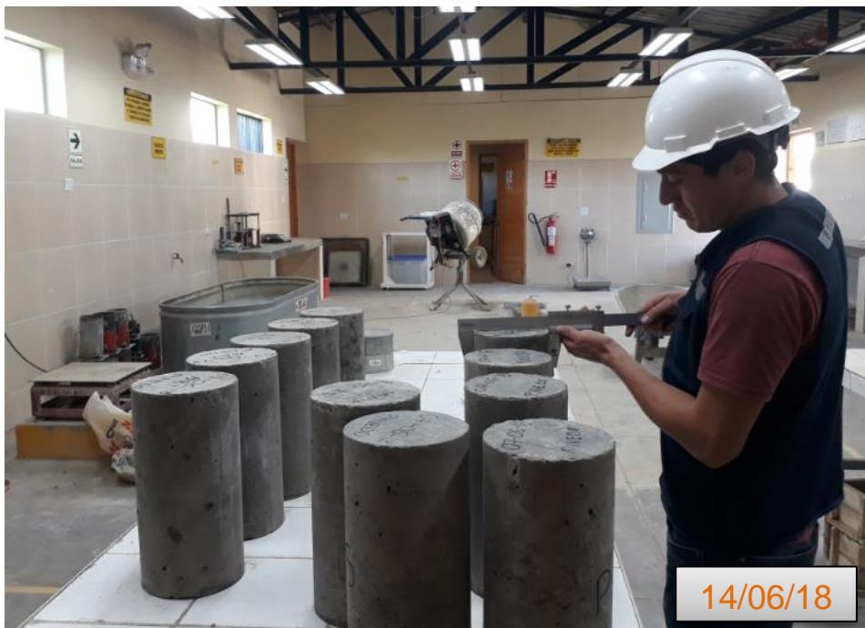
Fotografía 20 Medición de diámetro y altura de probetas cilíndricas.
