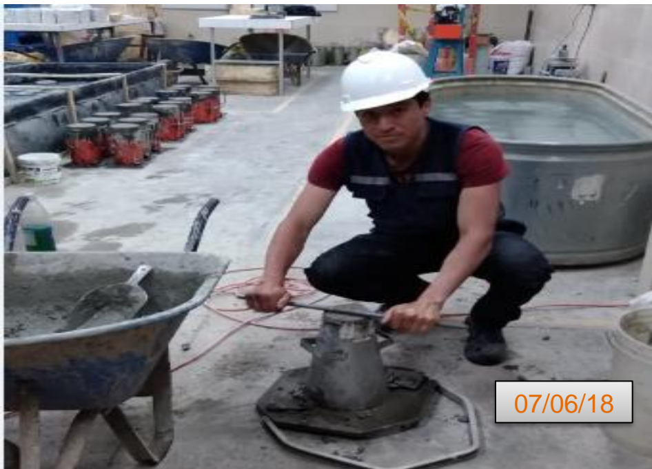
Fotografía 18 Ensayo de asentamiento del concreto fresco.
