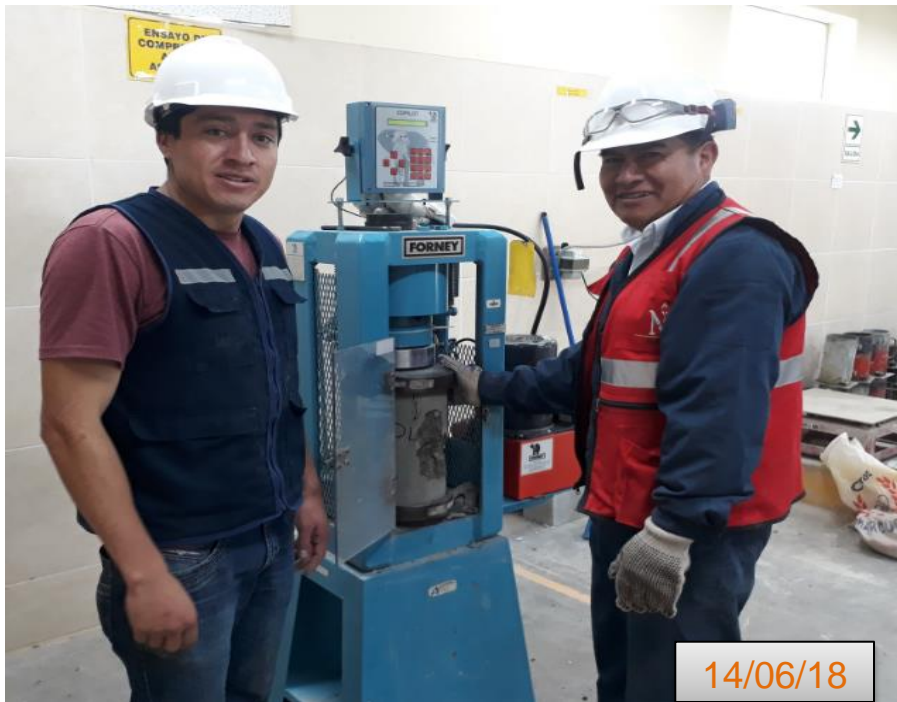
Fotografía 21 Rotura de probetas cilíndricas junto al laboratorista Víctor Minchan Cuzco.
