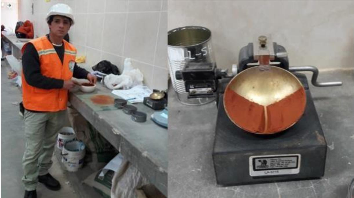
*Fotografía 12. Ensayo de Límites de Consistencia (Límite Plástico)*
