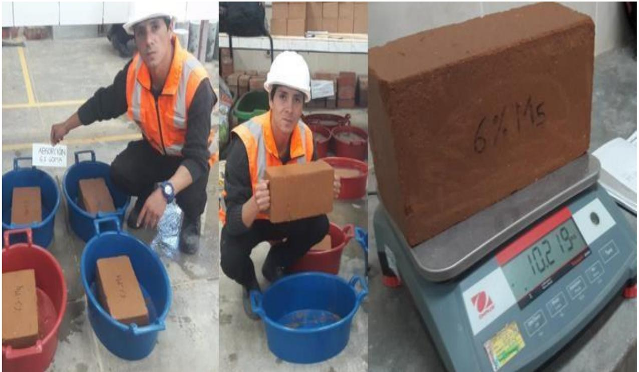
Fotografía 27. Ensayo de Absorción a la Muestra con 9% de adición de goma aloe vera.
