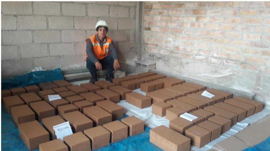
*Fotografía 21. Bloques de tierra comprimida en Laboratorio de la UPN para Realizar las Respectivas Pruebas*
