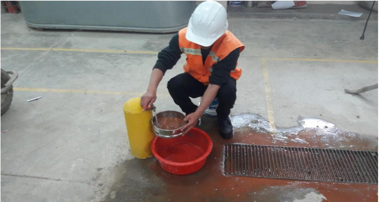
*Fotografía 10. Tamizado de Análisis Granulométrico por Lavado*
