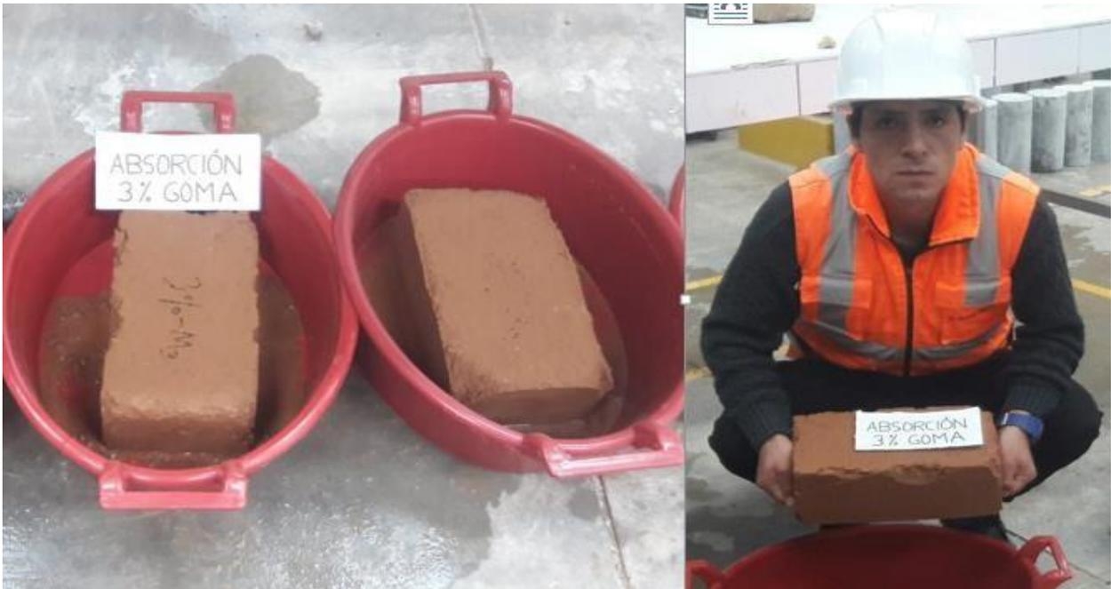
Fotografía 26. Ensayo de Absorción a la Muestra con 6% de adición de goma aloe vera.
