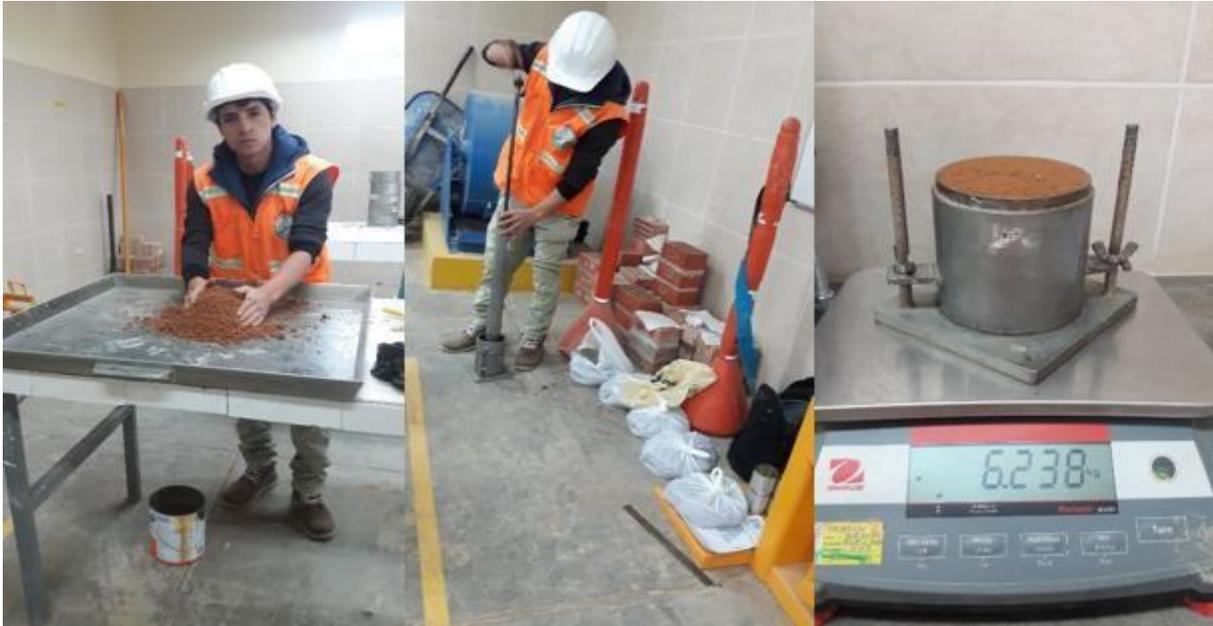
*Fotografía 16. Preparación de Material para Realizar los Bloques de Tierra Comprimida.*
