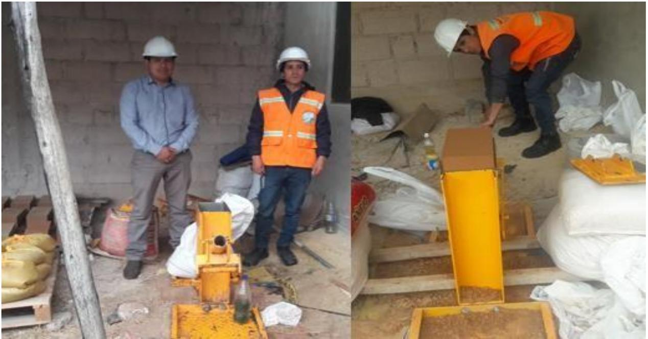
*Fotografía 18. Elaboración de los Bloques de Tierra Comprimida por la Maquina Cinva Ram*
