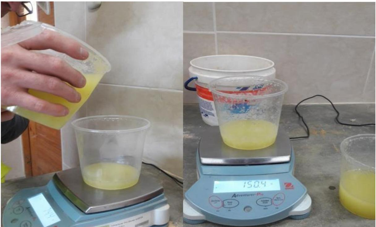
*Fotografía 15. Mezcla, Compactación y Peso de Molde más Muestra Durante la Realización del Proctor Modificado*
