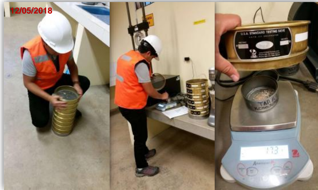
Fotografía 7 - Pasando muestra por los tamices y pesando lo retenido en cada malla.
