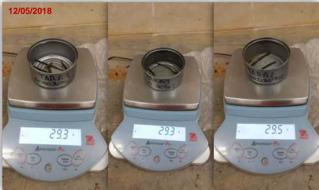
Fotografía 11 - Muestra tomada de límite líquido para sacar su contenido de humedad.
