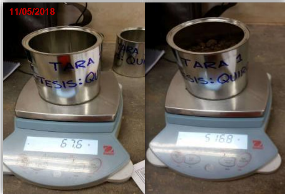
Fotografía 5 - Peso de tara y material natural para contenido de humedad.
