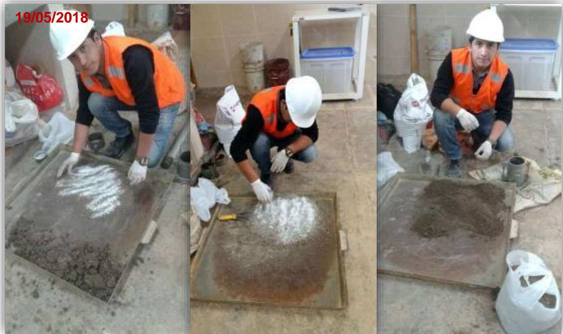
Fotografía 13 - Incorporación de Cal Hidratada, para ensayo de Proctor Modificado.
