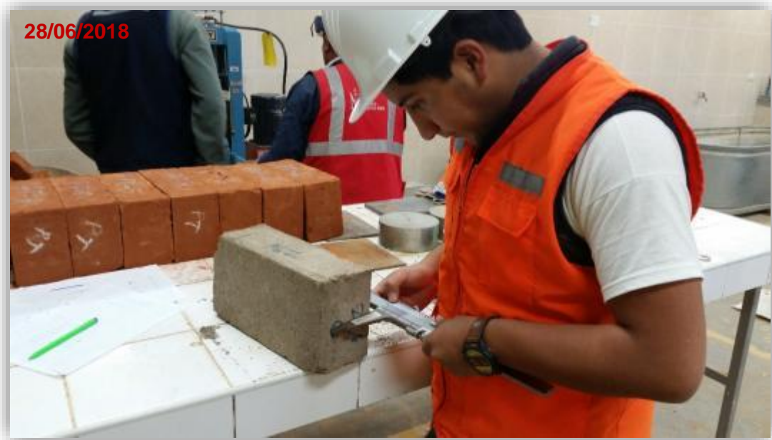
Fotografía 17 - Medida de los especímenes antes de realizar ensayos a compresión y flexión.
