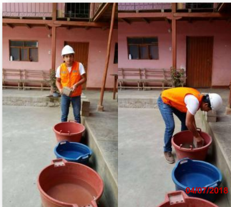
Fotografía 20 - Adobes sometidos a ensayo de Absorción.
