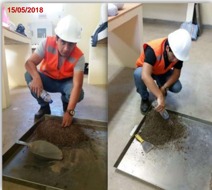
Fotografía 11 - Muestra tomada de límite líquido para sacar su contenido de humedad.
