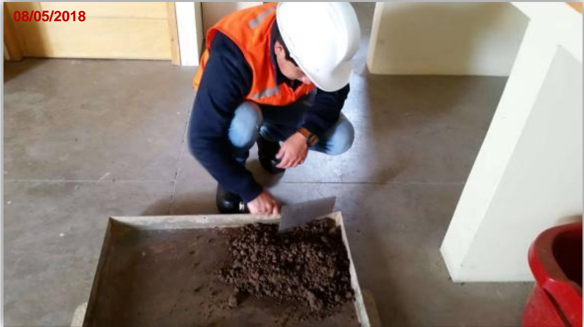
Fotografía 3 - Material para contenido de humedad.
