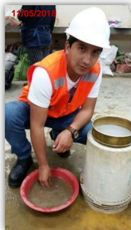
Fotografía 6 - Lavado de material para ensayo de granulometría.
