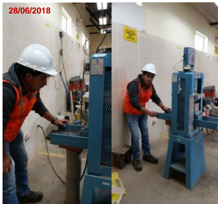
Fotografía 18 - Realización del ensayo a compresión y flexión.
