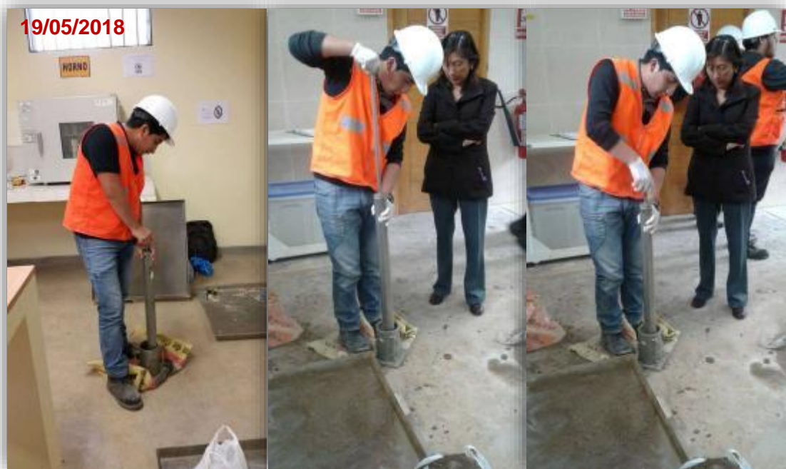
Fotografía 14 - Dando los 25 golpes con el pisón, bajo la supervisión de la Ingeniera de Suelos.
