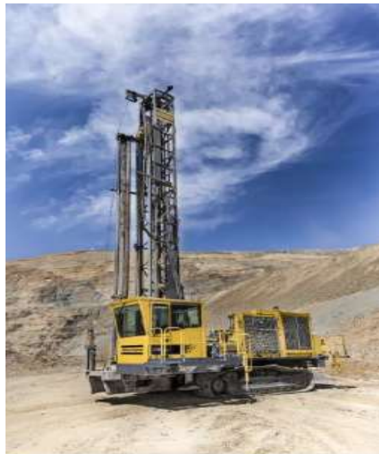
Ilustración 2: Perforadora DML-Atlas Copco.
