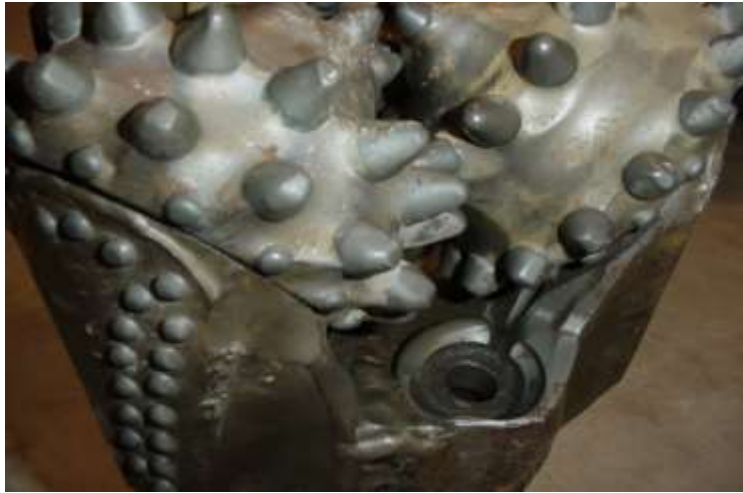
Ilustración 4: Broca desgastada por la operación del tricono.
