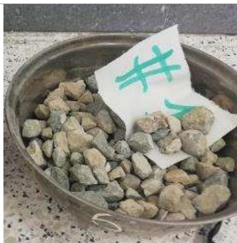
*Figura 42:*” Cuarteo del agregado grueso.” (10)
