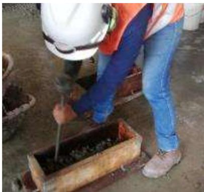
*Foto 33:* Se añadió el concreto en molde de la viga.
