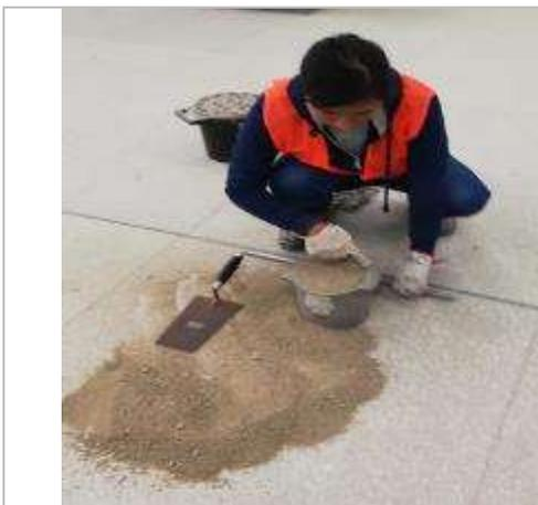
*Figura 47:* Retiro del material excedente del molde.
