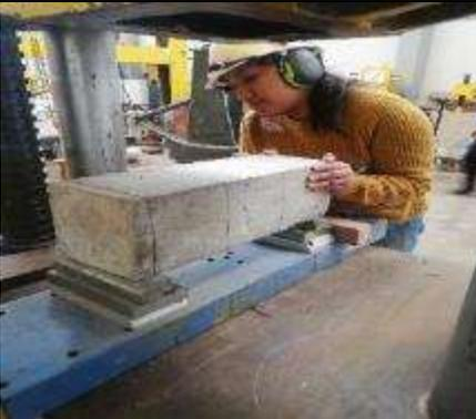
*Foto 57:* Colocando la viga a los tercios, para ser sometida a carga.
