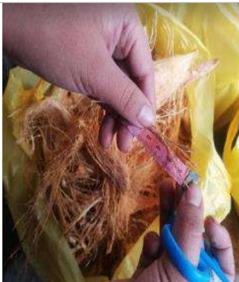
*Figura 36:* Corte de 5cm de fibra de coco
