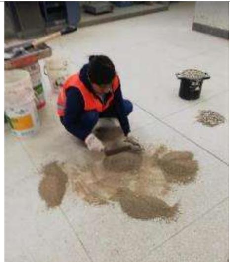
*Figura 40:”Cuarteo del agregado fino”* (10)
