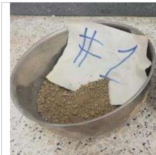
*Figura 41:*Cuarteo del agregado fino
