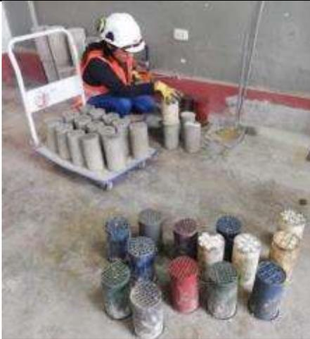
*Foto 39:* Pasada las 24h, se procedió a desencobrar las probetas.
