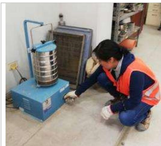
*Figura 43:* Se colocó en el tamizado mecánico por 2 min.
