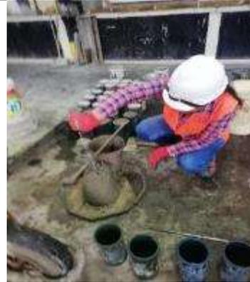
*Foto20:* Se realizó el SLUMP para cada diseño.
