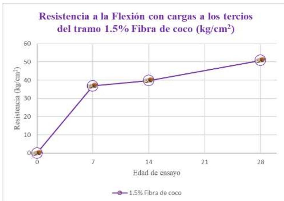
Figura 74: Comportamiento en el tiempo con 1.5% de fibra de coco; Flexión con carga a los tercios del tramo. Fuente: Elaboración propia
