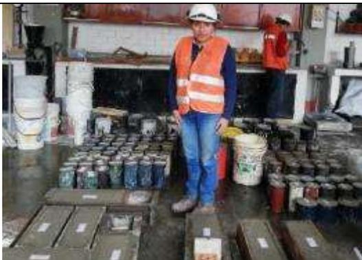
*Foto 35:* Los las vigas y probetas vaciadas, de acuerdo los diseños realizados de 0%, 1.5% y 2.0%.
