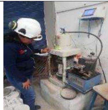
*Foto 42:* Se realizó el ensayo de compresión con las probetas cilíndricas. Fuente propia,2019
