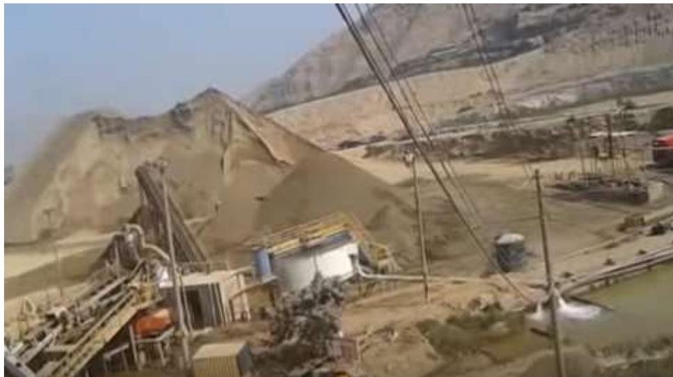
*Figura 20:* Se observa el lavado del agregado fino en el pozo de lodo para poder retirar las impurezas. Fuente: Foto propia 2019
