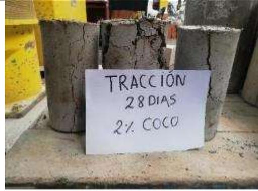
*Foto 56:* Probetas sometida a tracción a los 28 días en diseño de 2% de fibra de coco.
