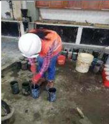
*Foto21:* Colocación de desmoldaste a las probetas.
