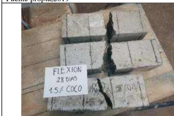
Foto 51: Viga sometida a flexión a los 28 días en diseño de 1.5% de fibra de coco.
