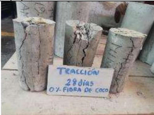
Foto 45: Probetas sometidas a tracción a los 28 días en concreto convencional.
