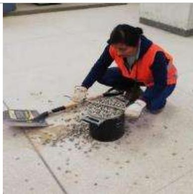
*Figura 53:* Se nivela el molde, para el retiro del material excedente.
