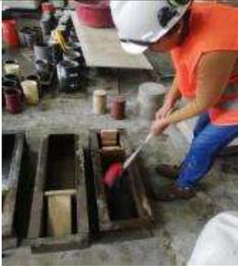
*Foto 31:* Se empezó a colocar el desmoldante a los moldes de viga y probetas.
