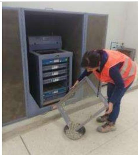
*Figura 46:* Se procedió a pesar el material retenido por tamiz.
