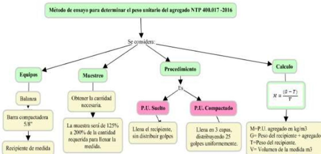
Figura 28: “Peso unitario del agregado” Fuente: (NTP 400.017, 2016)
