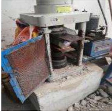
Foto 43: Se realizó el ensayo de tracción a compresión diametral.
