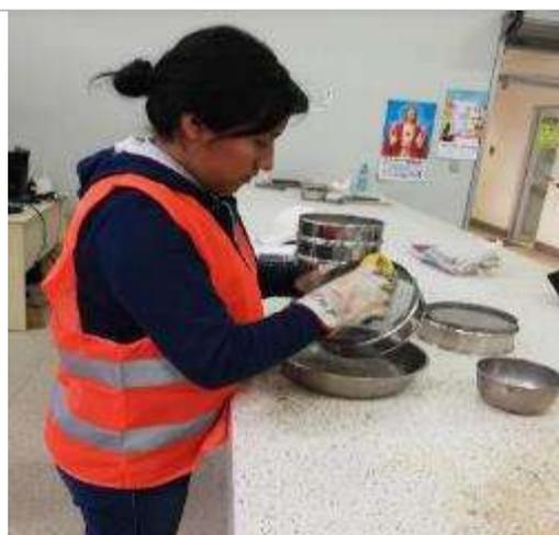
*Figura 44:* Se pesó el material retenido por tamiz.
