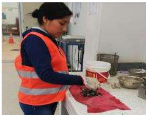
*Figura 55:* Se saca el espécimen del agua y se seca eliminando el agua superficial visible.
