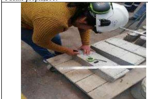
Foto 53: Obtención de medidas de viga.
