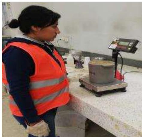
*Figura 48:* Se peso el agregado más el molde metálico.
