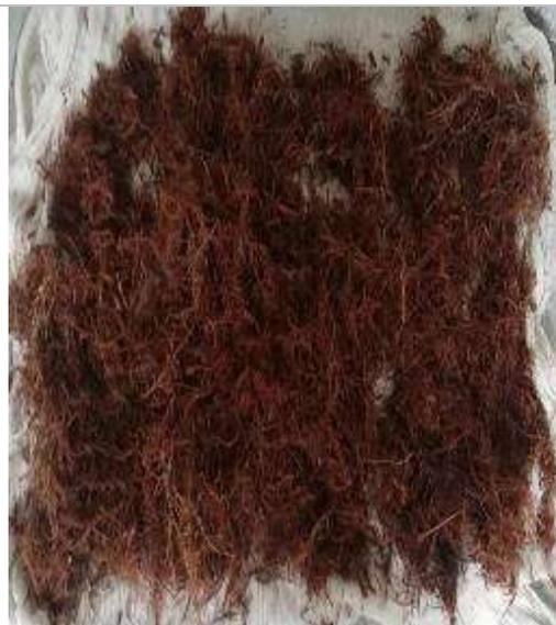
*Figura 37:* Secado al ambiente de la fibra de coco.
