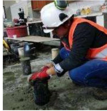
*Foto 34:* Se añadió el concreto en molde la probeta.
