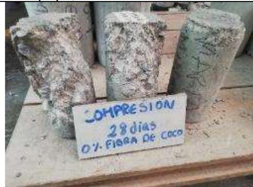
Foto 46: Probetas sometidas a compresión a los 28 días en concreto convencional.
