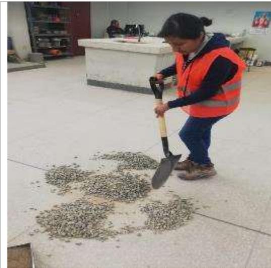
*Figura 39:”Cuarteo del agregado grueso”*
