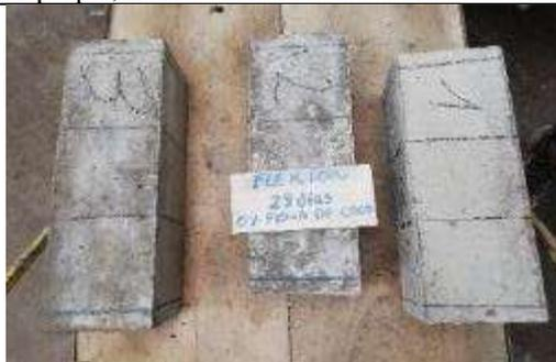
Foto 47: Vigas sometidas a flexión a los 28 días en concreto convencional.
