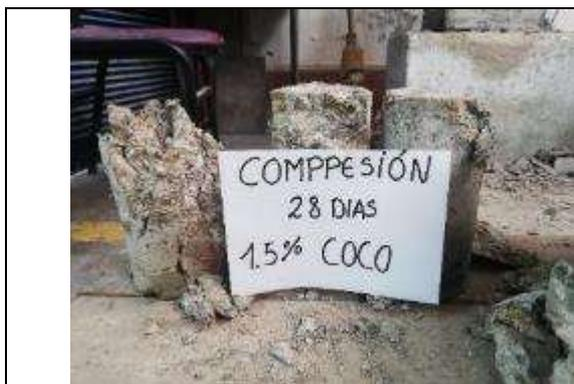
Foto 49: Probetas sometidas a Compresión a los 28 días en diseño de 1.5% de fibra de coco.
