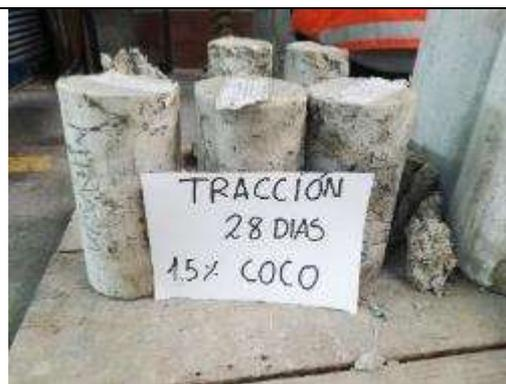
Foto 50: Probetas sometida a tracción a los 28 días en diseño de 1.5% de fibra de coco.
