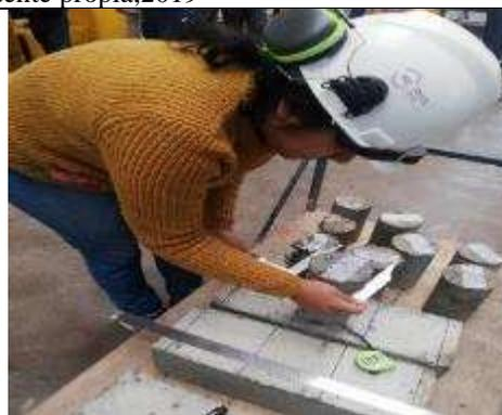
Foto 52: Obtención de medidas de probeta.
