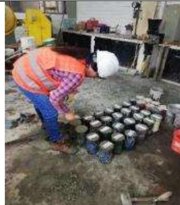
*Foto22:* Colocación de rotulo a cada probeta según el diseño.
