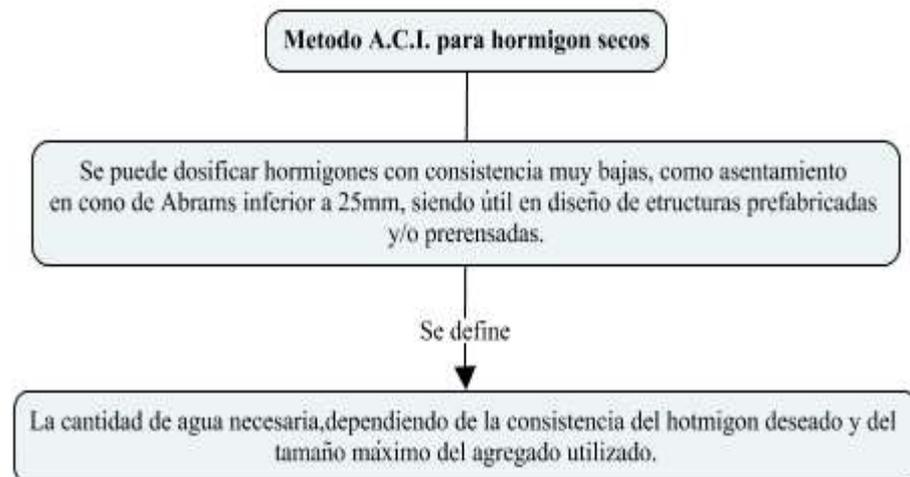
Figura 11: Método A.C.I. para hormigón secos
