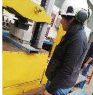
Foto 44: Se realizó el ensayo a flexión con carga a los tercios del tramo en las vigas.
