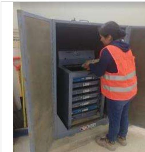
*Figura 45:* Se colocó en el tamizado mecánico por 2 min.
