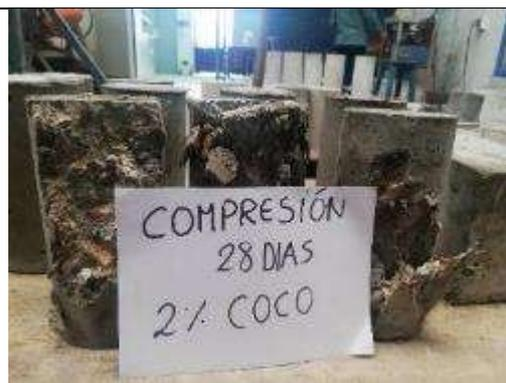
Foto 54: Probetas sometidas a Compresión a los 28 días en diseño de 2% de fibra de coco.
