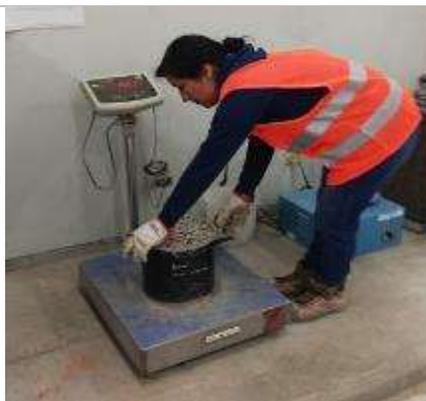
*Figura 54:* Se pesa el agregado grueso más el molde, para obtener valores de P.U. compactado.
