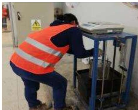
*Figura 56:* Se ubica el ejemplar en el interior de la canastilla y se determina el peso sumergido” (Aburto, 2017)
