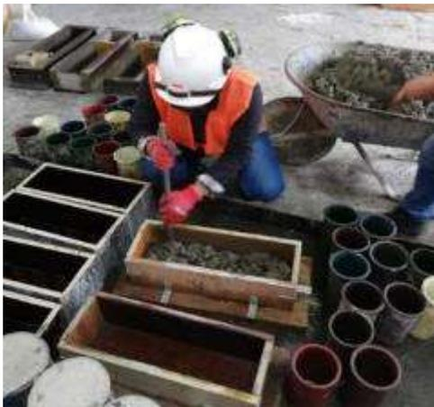
*Figura 62:* Se procedió varillar cada molde, para la elaboración de la viga de concreto.
