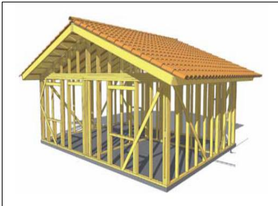
Figura 17. Sistema constructivo Madera.
