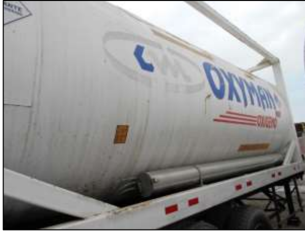
Figura 3. Cisterna de transporte del oxígeno. Fuente: Elaboración propia.
