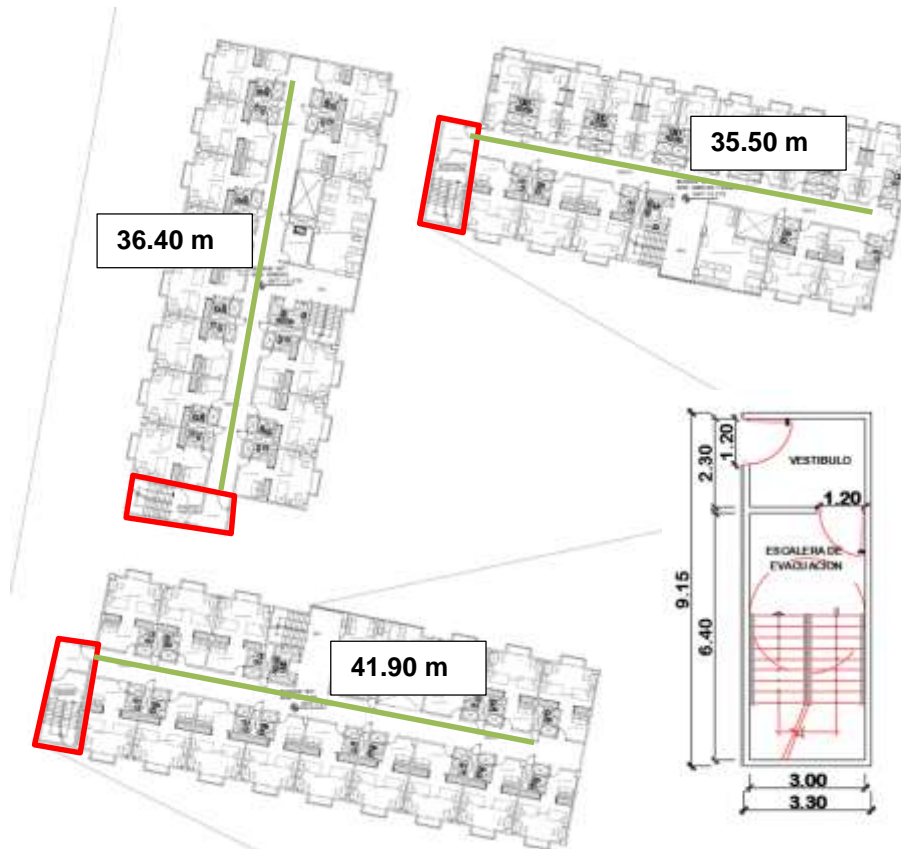
Figura 85: Escaleras de evacuación bloque A
