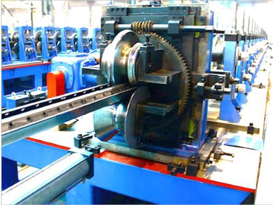
*Figura 38 - Proceso de Roll-forming*
