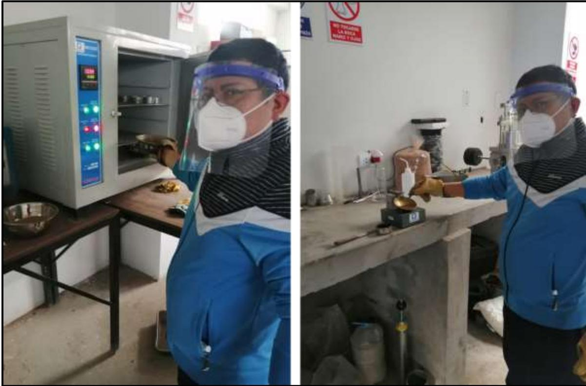
*Figura 36: Materiales colocados en el horno y cálculo del límite líquido.*
