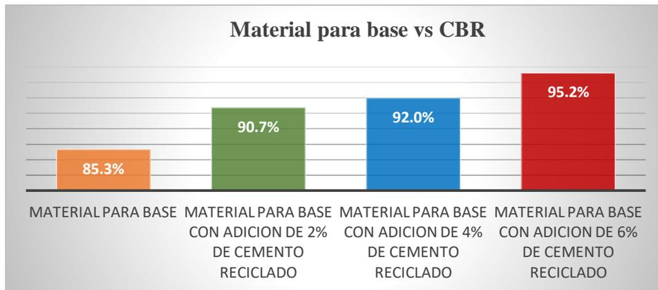
*Figura 27: Material para base vs CBR*
