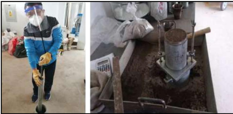
*Figura 21: Compactación de material mezclado con cemento*
