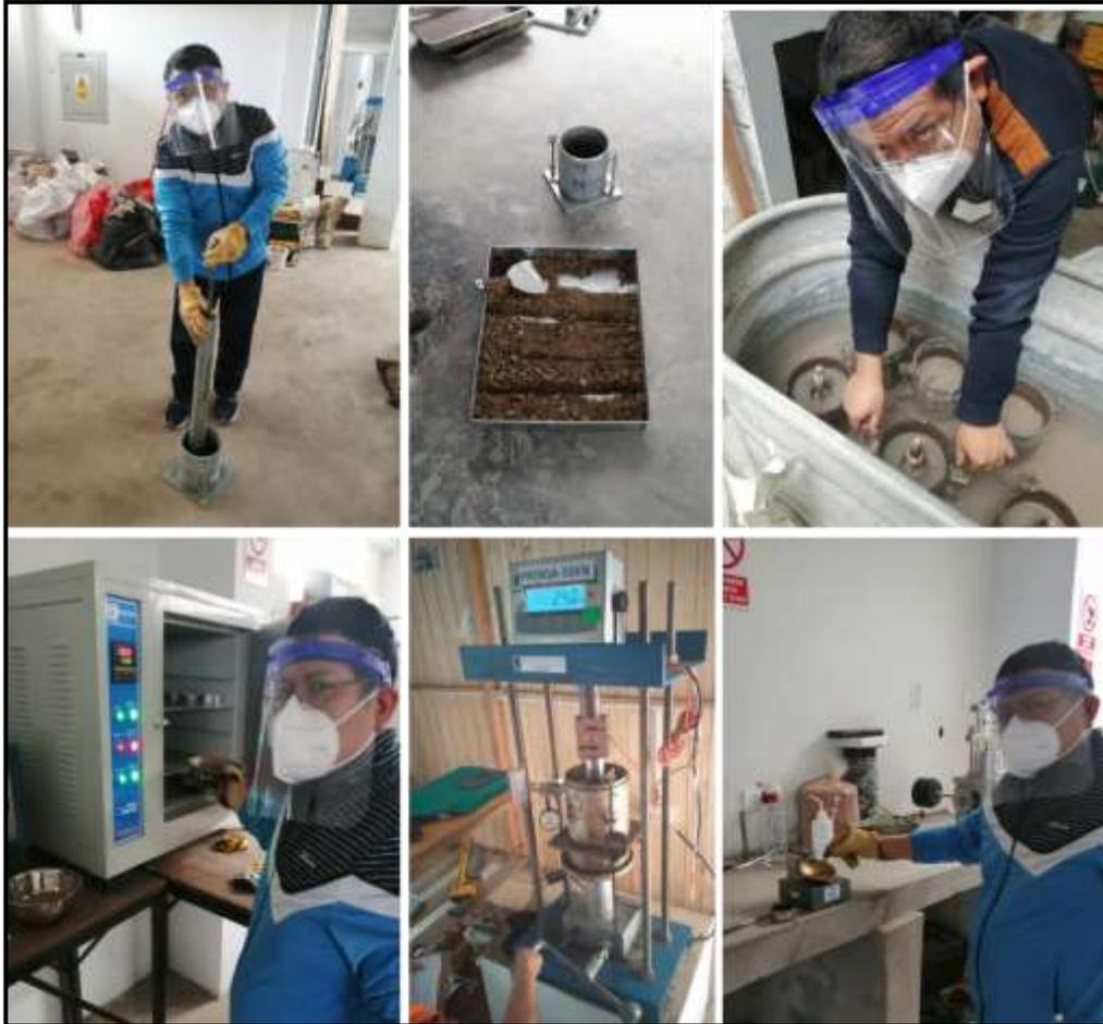
*Figura 12: Realizando el ensayo del CBR*
