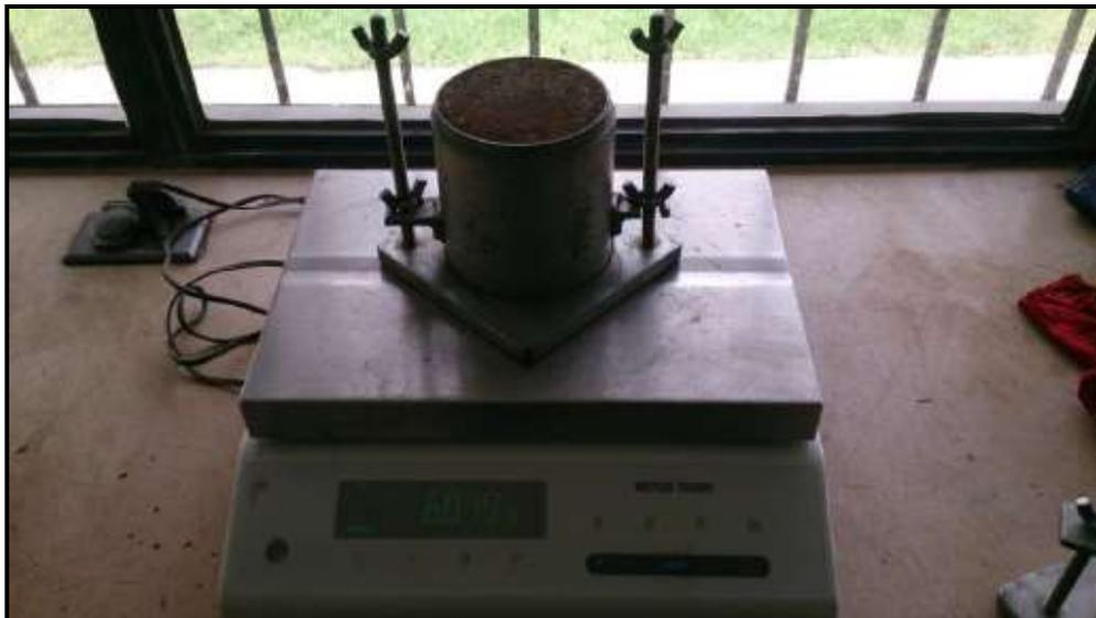
*Figura 17: Molde de Proctor*
