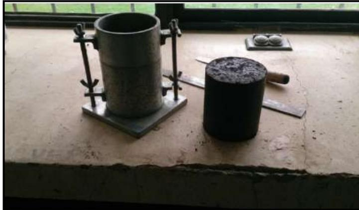
*Figura 22: Molde extraído del equipo de compactación*
