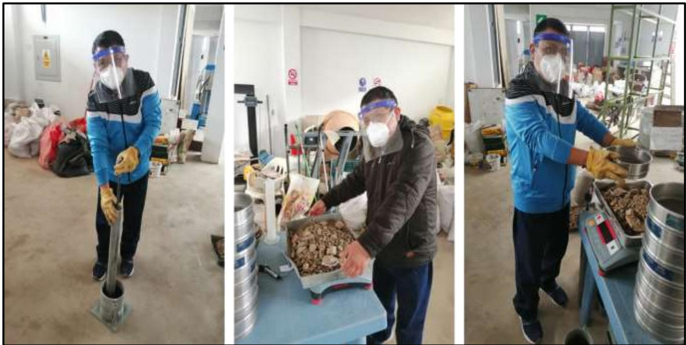
*Figura 37. Pesado de materiales y PROCTOR.*
