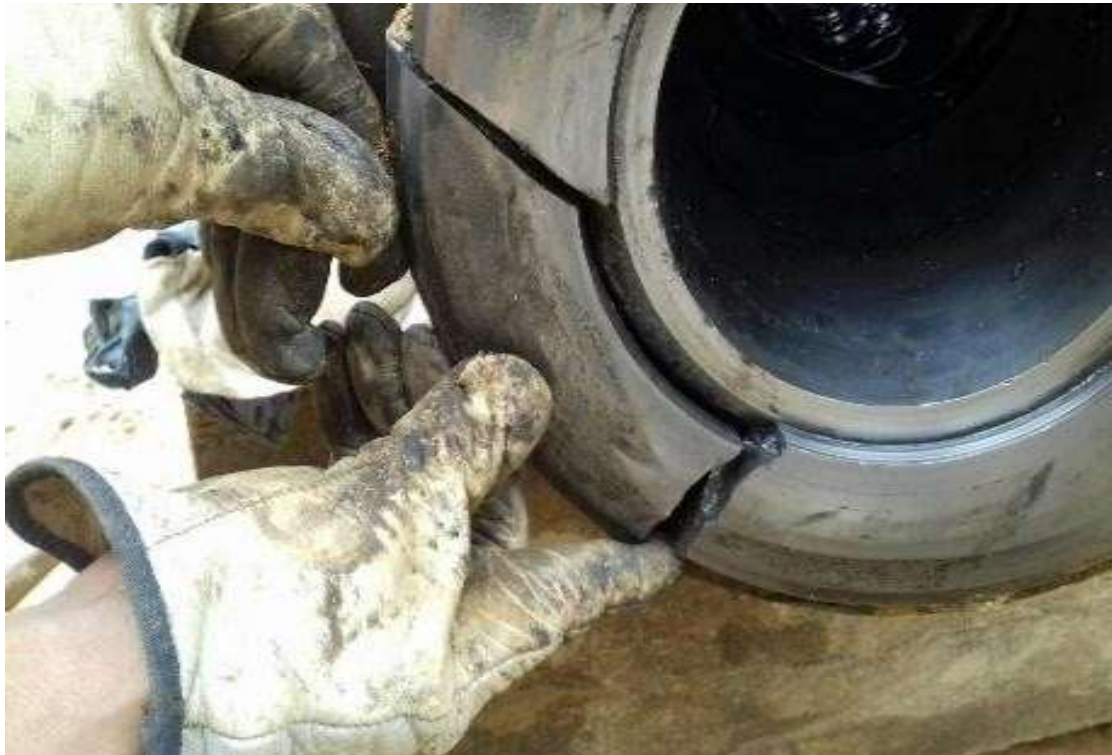
Ilustración 4: Ruptura de componentes por fatiga.
