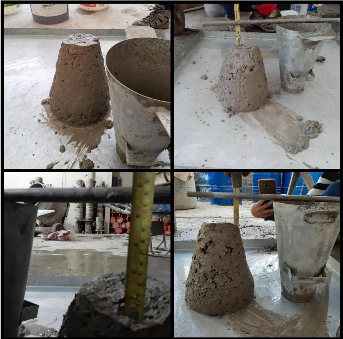
*Figura 9 Ensayos de slump*
