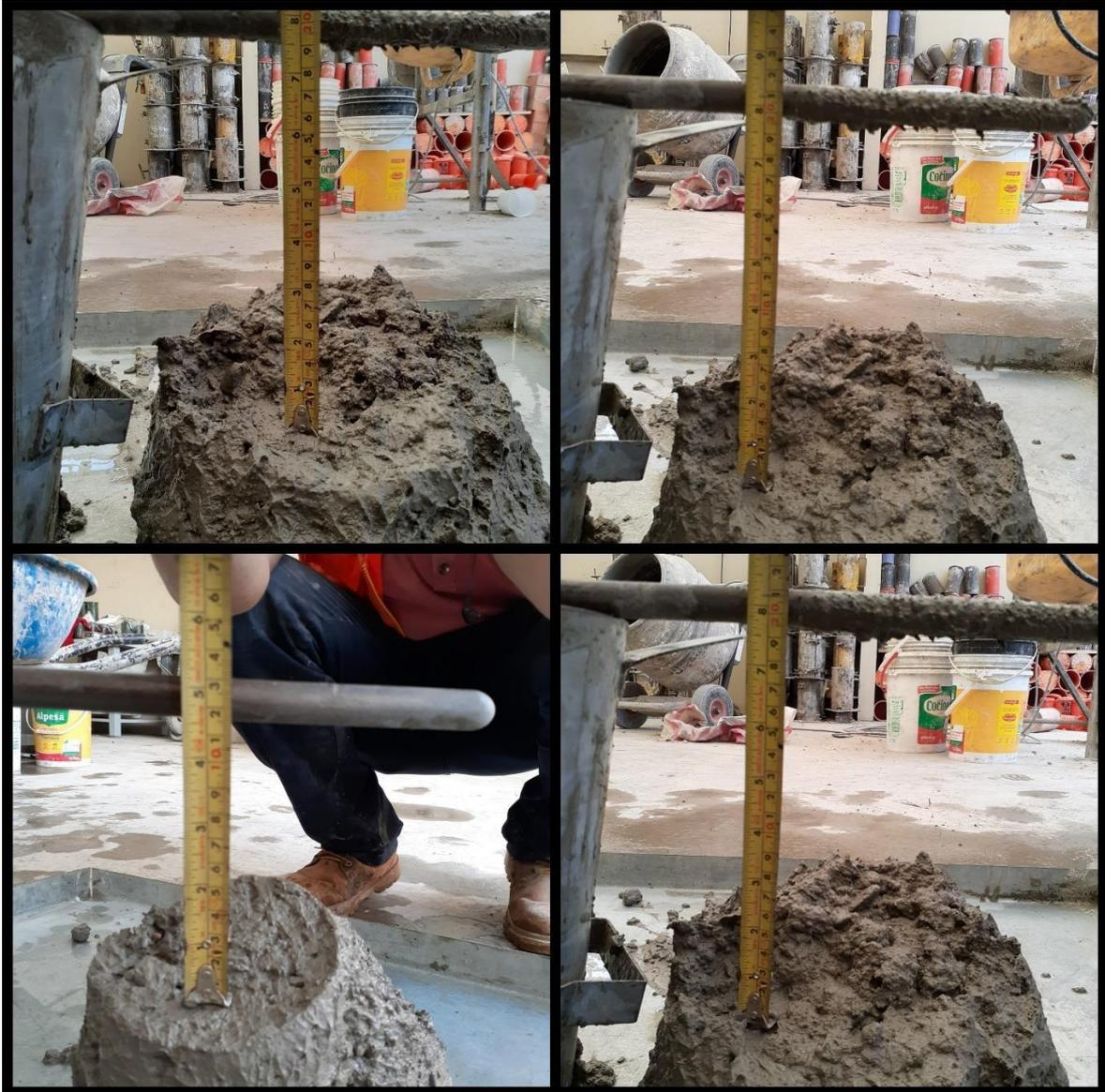
*Figura 14 Ensayo de slump para diferentes porcentajes de adición*
