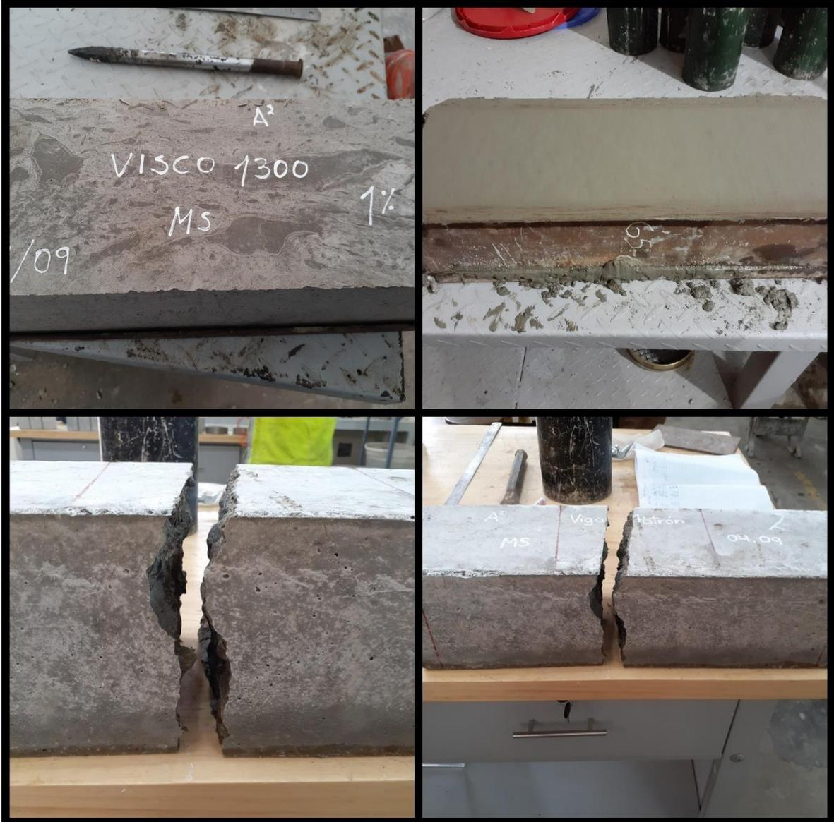
*Figura 13 Ensayo de resistencia a la flexión*
