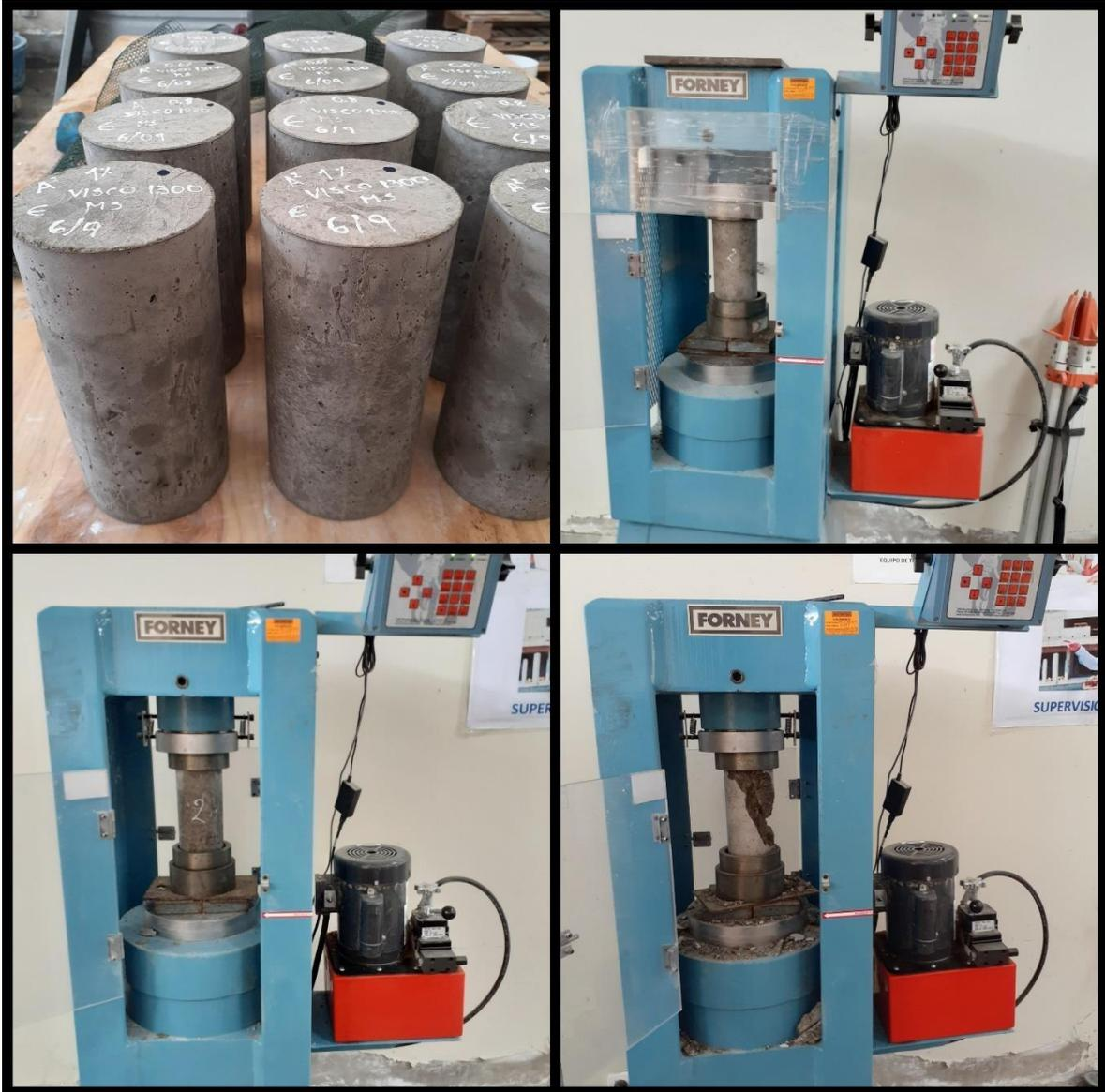
*Figura 15 Resistencia a la compresión de las diferentes adiciones de Sika Viscocrete 1300*
