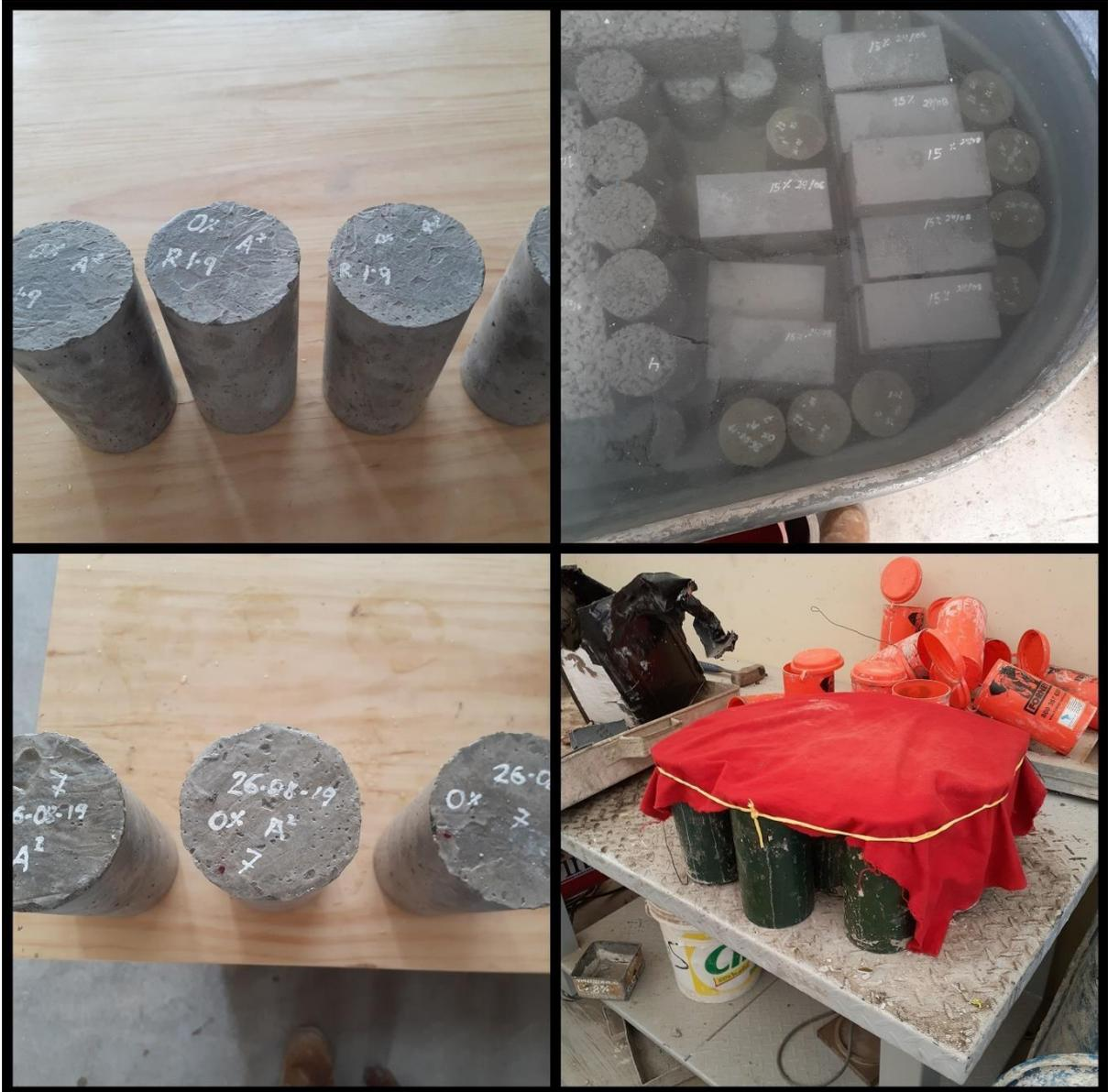
*Figura 10 Muestras para ser ensayadas a compresión*
