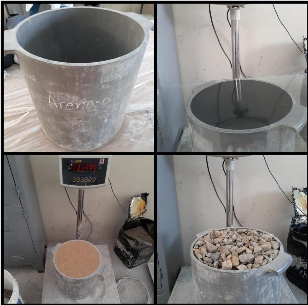
*Figura 7 Peso de agregados*
