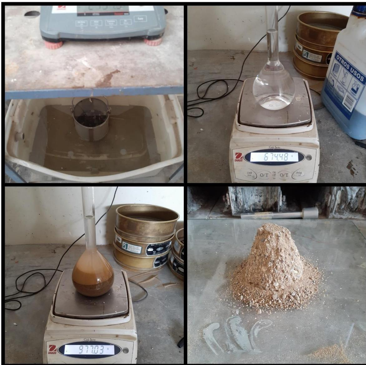
*Figura 11 Ensayos de caracterización de agregados*
