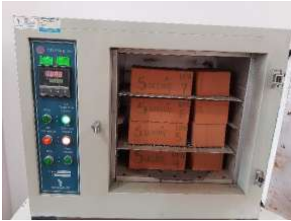
Figura 28: Secado de las muestras en horno 100° C \pm 5°C durante 24 horas.
