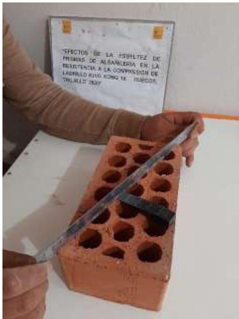
Figura 26: Toma de medida de alabeo cóncavo
