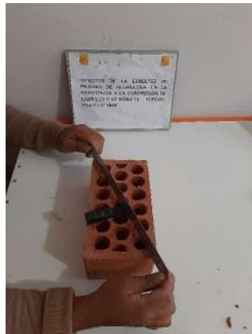
Figura 27: Toma de medida de alabeo cóncavo
