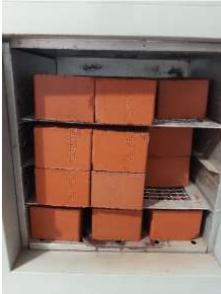
Figura 21: Secado de las muestras en horno 100^{\circ}\text{C} \pm 5^{\circ}\text{C} durante 24 horas.
