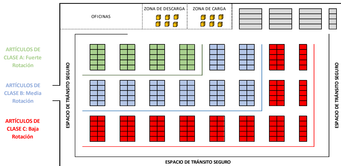
Figura 15. Diagrama de Layout mejorado el almacén de la empresa constructora.
