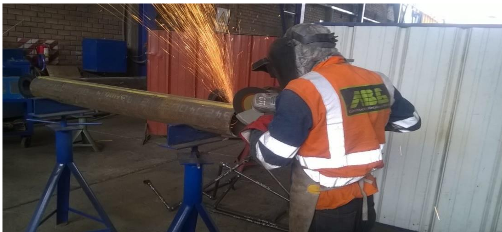
Figura 12 Proceso de biselado. Fuente: ABG S.R.L.
