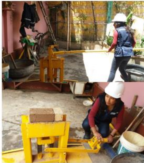
Figura 57: Compactación, enrase y desmoldamiento de la unidad.
