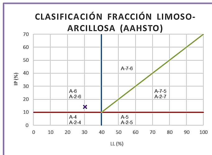
Figura 39: Clasificación del material sin Synadenium Grantii (AAHSTO)
