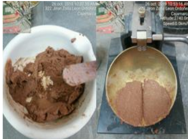
Figura 51: Desarrollo del ensayo de Plasticidad.
