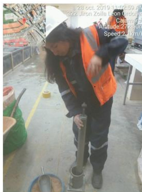
Figura 52: Desarrollo del ensayo de Proctor Modificado
