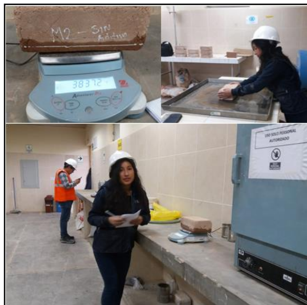
Figura 33: Realizando el Ensayo de Succión de la unidad.
