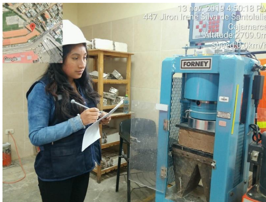
Figura 67: Ensayo de la resistencia a compresión de la unidad, elaborada de residuos de construcción a los 7 días de curado.
