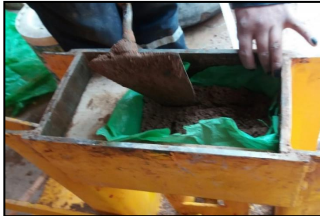
Figura 22: Mezcla depositada en la máquina Cinva Ram
