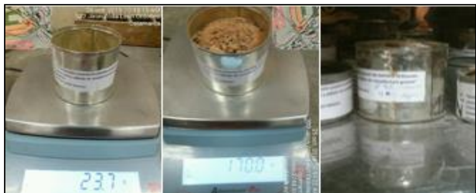
Figura 15: Procedimiento del Ensayo de Contenido de Humedad.
