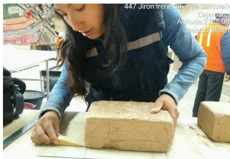
Figura 64: Ensayo de alabeo de la unidad elaborada de residuos de construcción.
