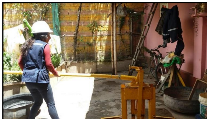
Figura 23: Compresión del material en la máquina Cinva Ram
