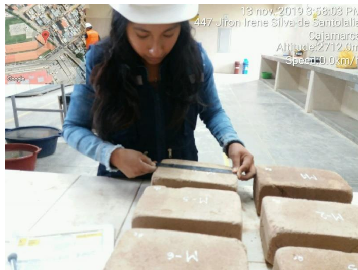
Figura 63: Ensayo de variación dimensional de la unidad elaborada de residuos de construcción.
