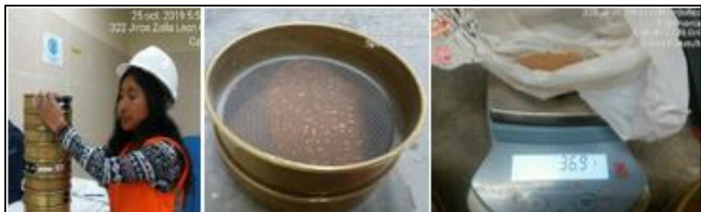
Figura 14: Procedimiento del Ensayo de Granulometría mediante el Método de Tamizado por Lavado.
