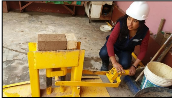
Figura 24: Desmoldamiento de la unidad en la máquina Cinva Ram
