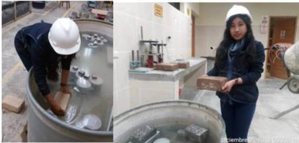
Figura 65: Ensayo de Absorción de la unidad elaborada de residuos de construcción.
