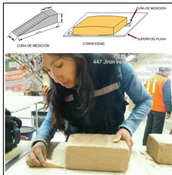
Figura 31: Medición del Alabeo en la unidad.
