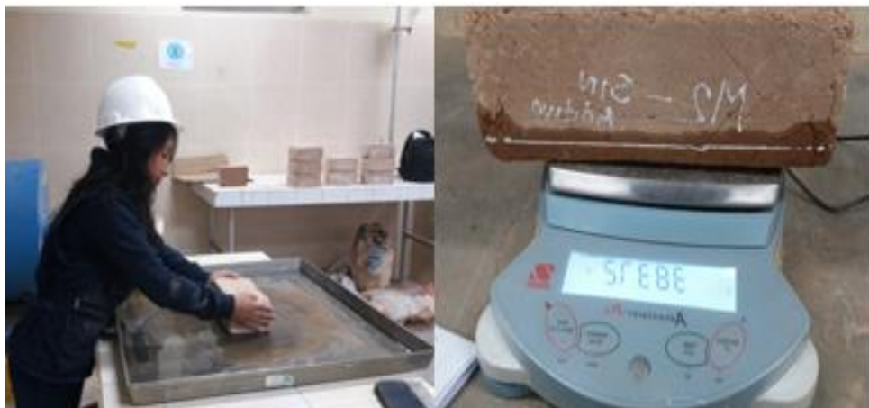
Figura 66: Ensayo de Succión de la unidad elaborada de residuos de construcción.
