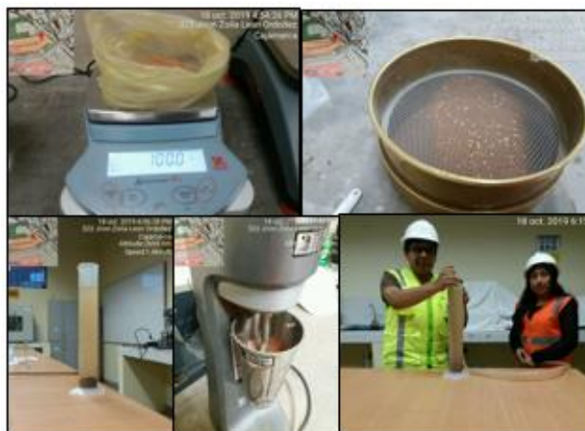
Figura 13: Procedimiento del Ensayo por Sifonaje.
