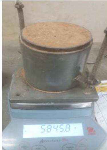
Figura 53: Muestra compactada en el Ensayo de Proctor Modificado
