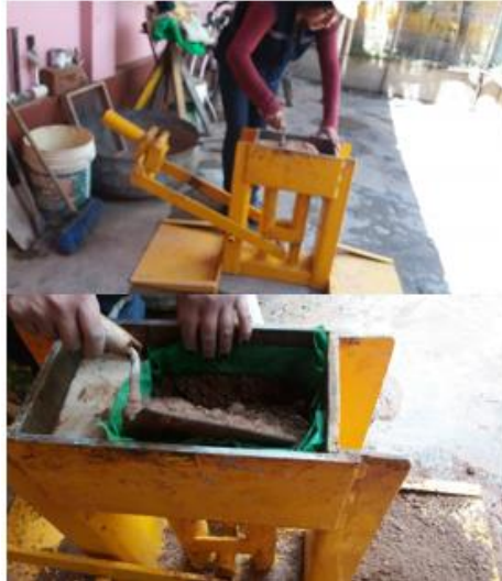
Figura 56: Colocación de la muestra en la máquina Cinva Ram
