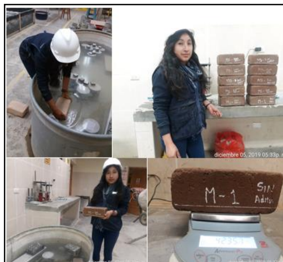
Figura 32: Realizando el Ensayo de Absorción.
