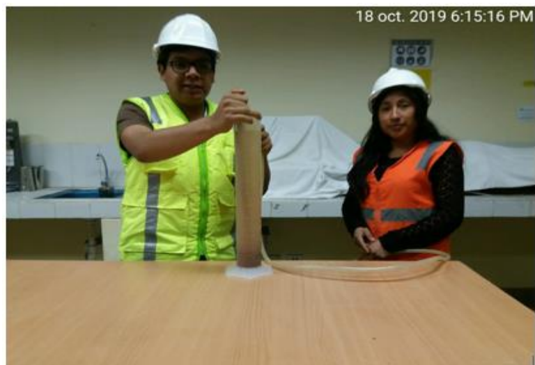
Figura 49: Realizando el ensayo análisis granulométrico por el método de Sifonaje.
