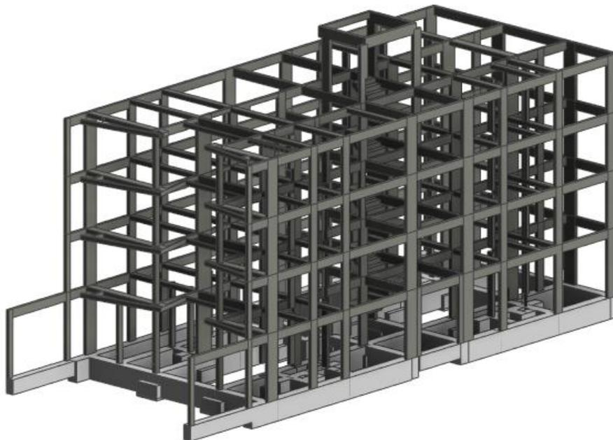
*Figura. 4.20 Modelo 3d Columnas y Vigas*
