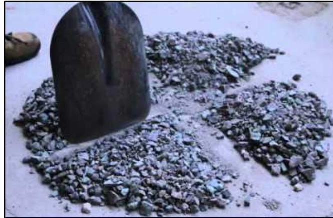
Figura 10. Cuarteo del Agregado Grueso (piedra chancada).
