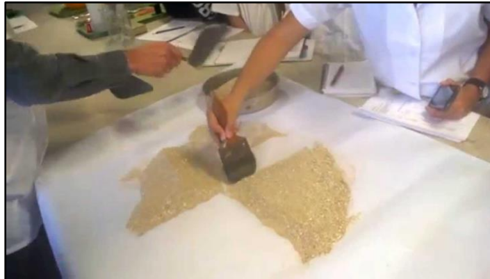
Figura 9. Cuarteo del Agregado Fino.
