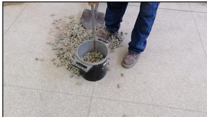
Figura 23. Peso unitario del material compactado del agregado grueso.
