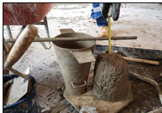
Figura 17. Ensayo al concreto fresco con el cono de Abrams.
