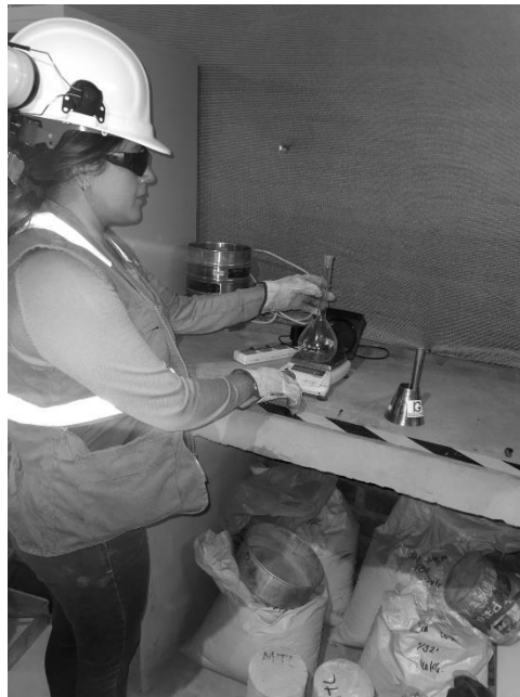
Figura 15. Frasco de Le Chatelier ensayo al agregado fino (arena gruesa).
