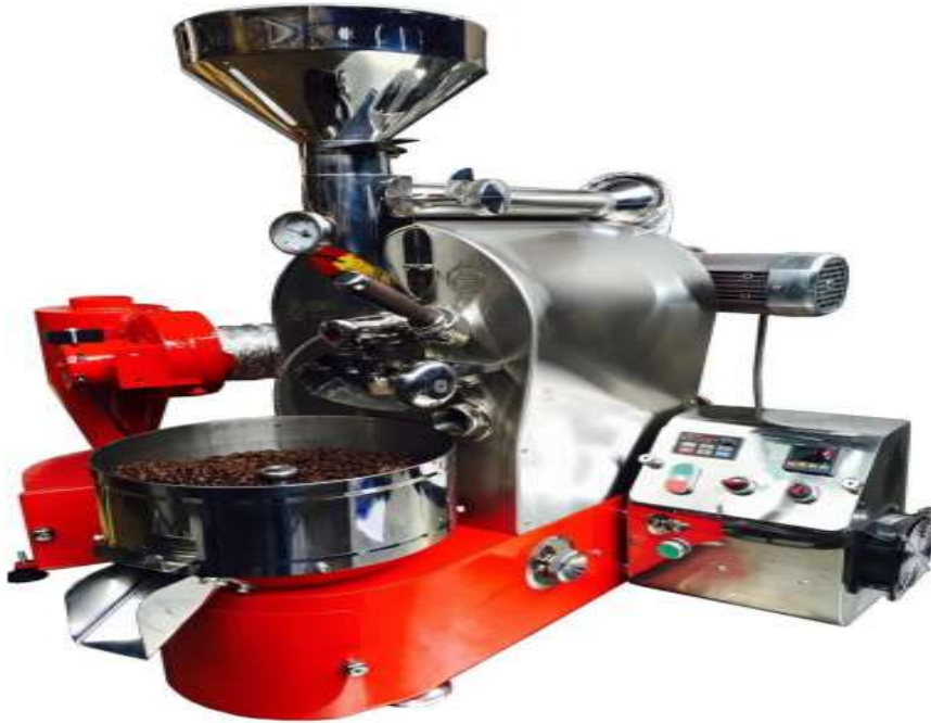
Figura 10. Máquina tostadora de capacidad de 2,5 kg por corrida.
