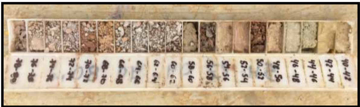
Figura 4: Extracción de muestra de chips, después de su paso por el ciclón.
