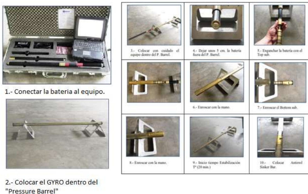
Figura 8: Proceso de armado, instalación y configuración del equipo Gyro Reflex.
