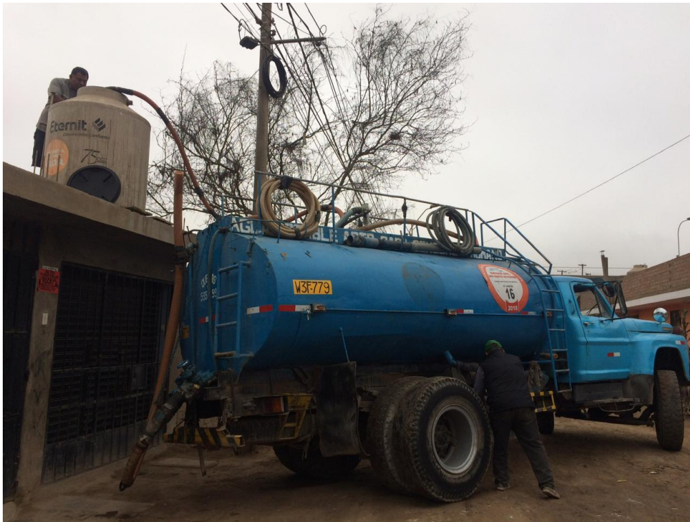
Figura 3. Camión cisterna abasteciendo de agua al tanque elevado
