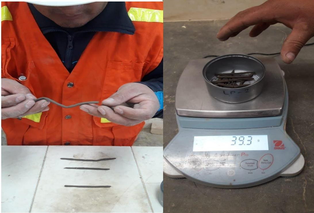
Figura 11. Realizando ensayo de límite plástico
