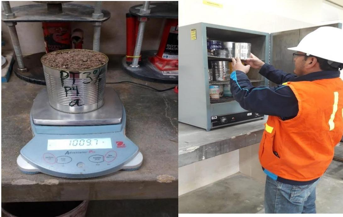
Figura 9. Peso de material para determinar contenido de humedad
