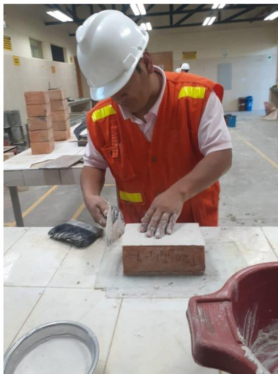
*Figura 28. Colocando yeso a las caras del ladrillo*
