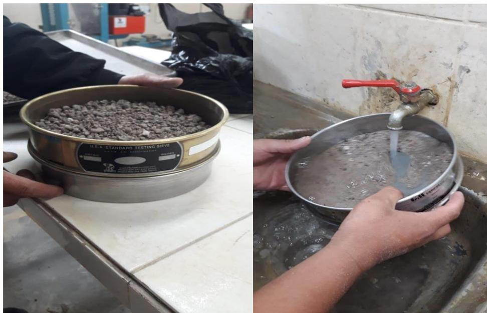
Figura 12. Ensayo de granulometría
