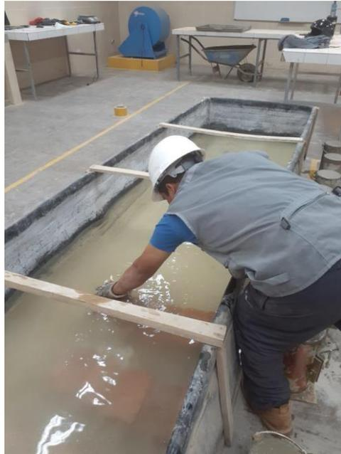
*Figura 27. Realizando el ensayo de Absorción*
