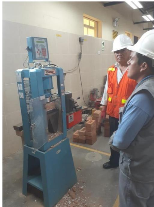
*Figura 30. Realizando el ensayo de resistencia a la compresión*
