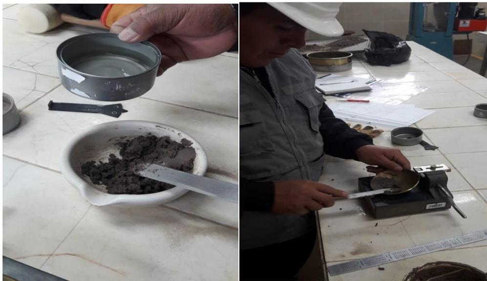
Figura 10. Realizando ensayo de límite líquido
