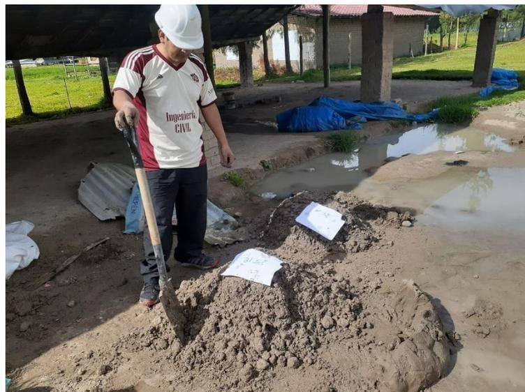
*Figura 16. Mezcla de los residuos con la arcilla listo para moldear*
