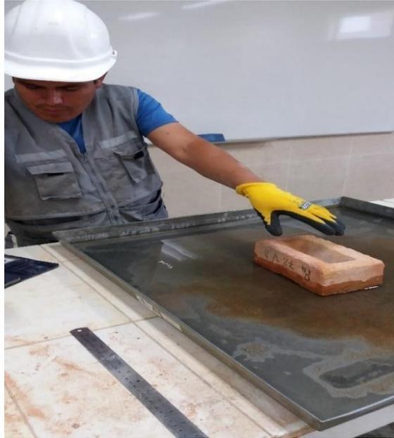
*Figura 25.* Realizando el ensayo de succión
