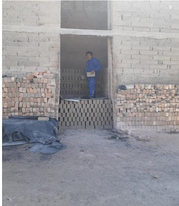
*Figura 21.* Colocación del ladrillo para la cocción
