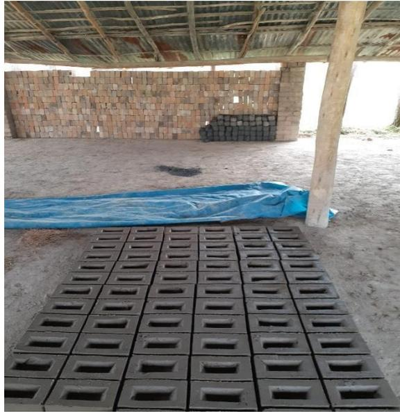
Figura 19. Ladrillos colocados para el proceso de secado
