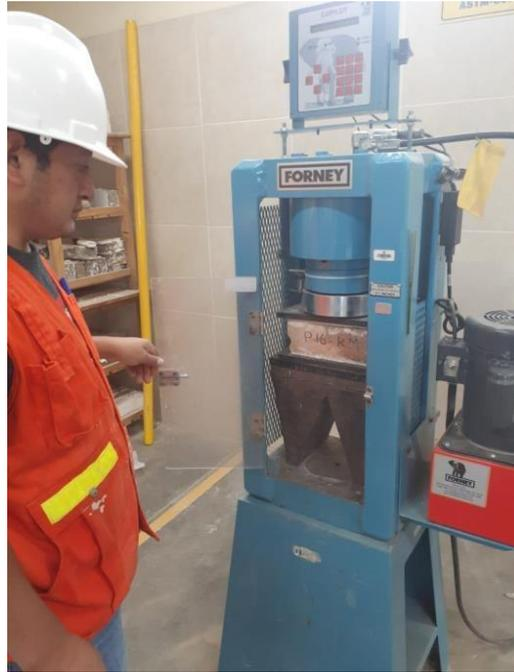
*Figura 29. Realizando el ensayo de resistencia a la compresión*
