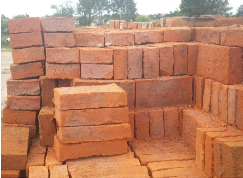
*Figura 23.* Ladrillo cocido después de sacarlos del horno
