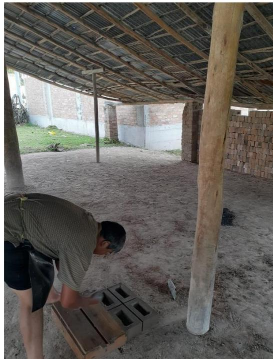
*Figura 18.* Colocando los ladrillos para el secado correspondiente
