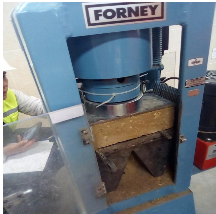
Figura 51 Realizando el ensayo a la resistencia a la flexión.
