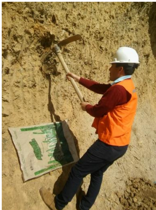
Figura 12 Extracción de la Muestra.
