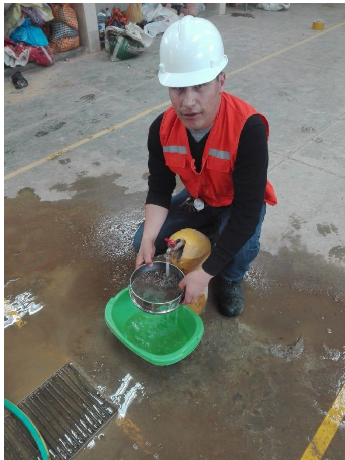
Figura 32 Lavado del Material por la Malla 200.
