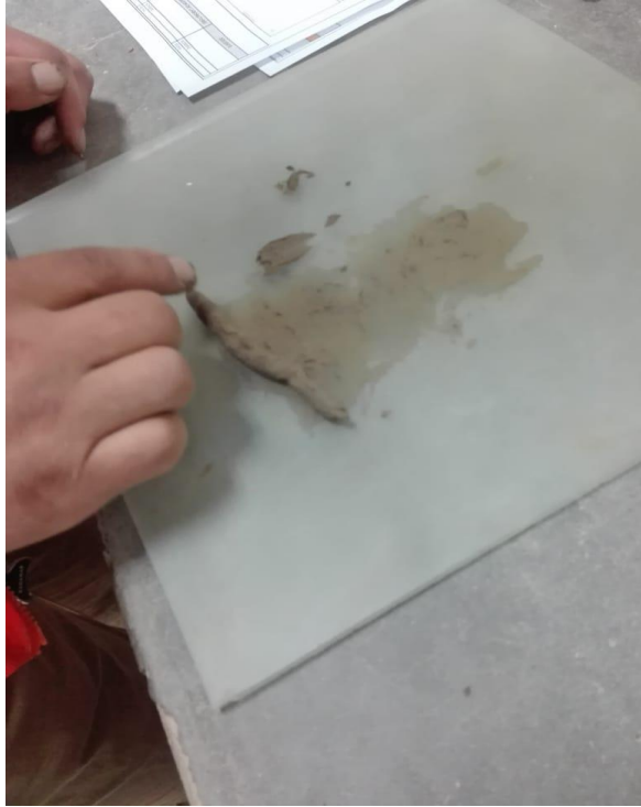
Figura 27 Determinación Limite Plástico.
