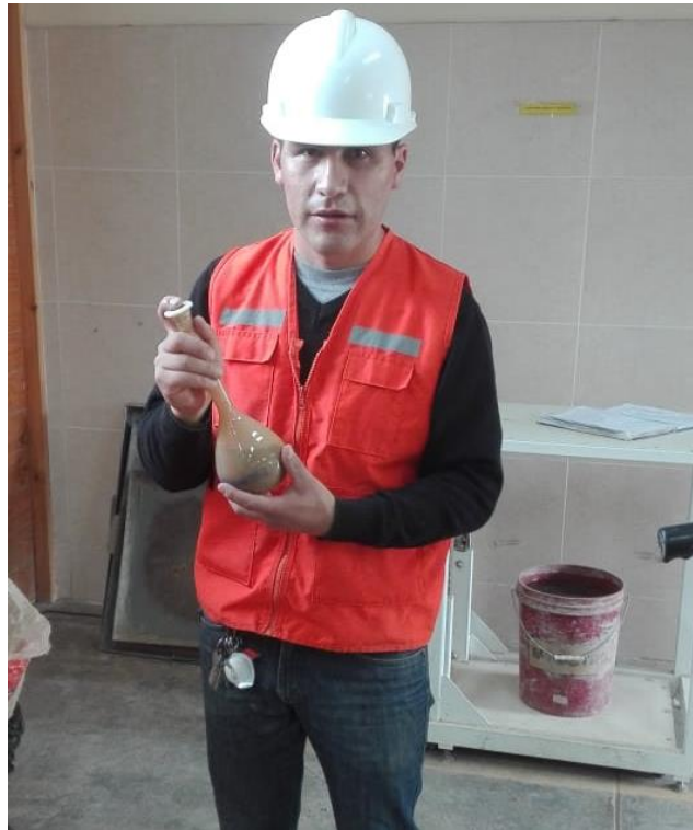
Figura 17 Preparación de la Muestra para Peso Específico.
