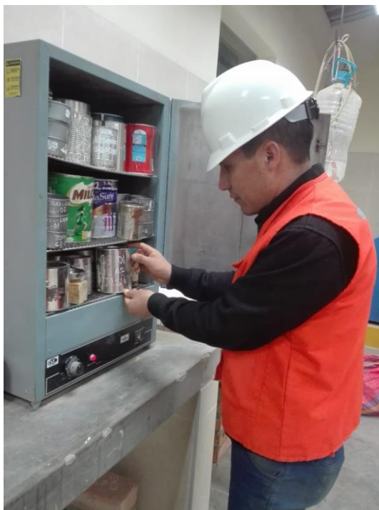
Figura 35 Retiro la Muestras colocadas en el Horno.
