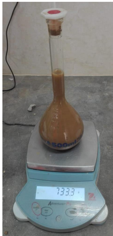
Figura 18 Pesado de la Fiola con material Fino y agua.
