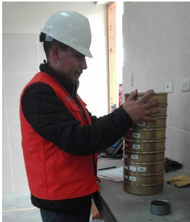
Figura 30 Zarandeo de la muestra seca por Lavado.
