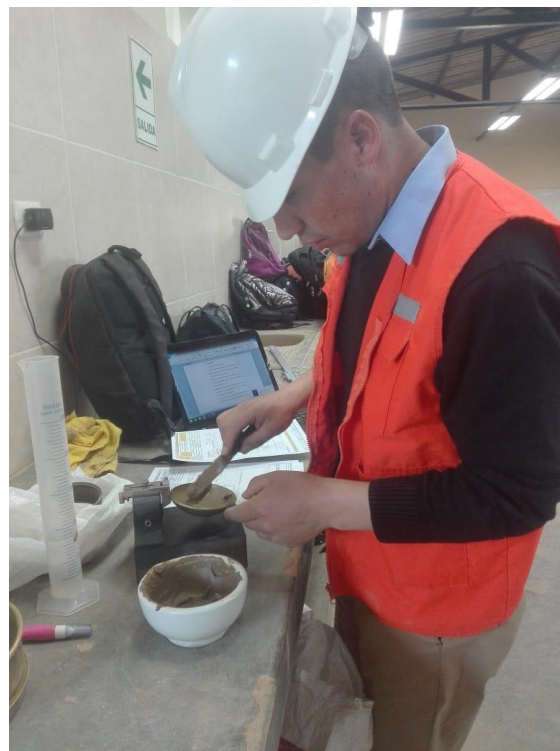
Figura 24 Colocación de la muestra (Casagrande).
