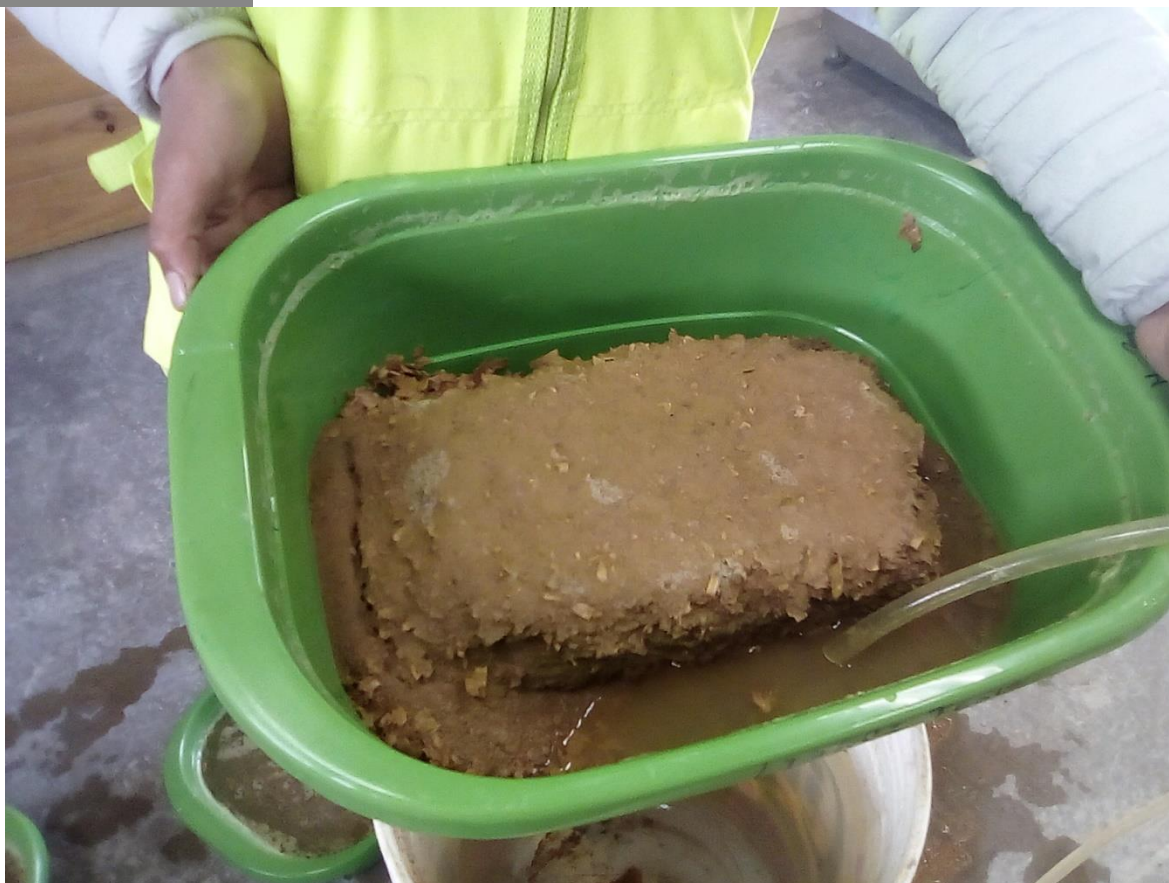
Figura 48 Adobe después de las 24 horas que fue sometido al ensayo de absorción.
