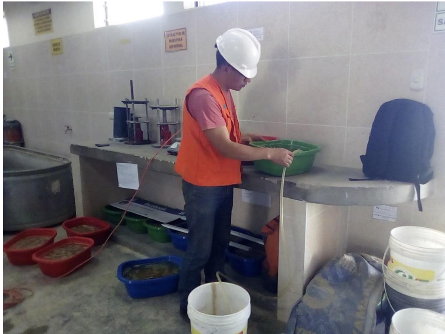
Figura 47 Extracción del agua de los adobes para medir la absorción.
