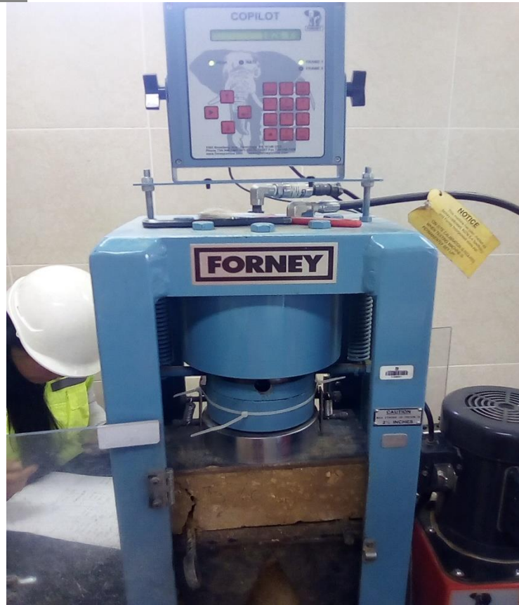
Figura 52 Observación de la falla de la resistencia a la flexión del adobe.
