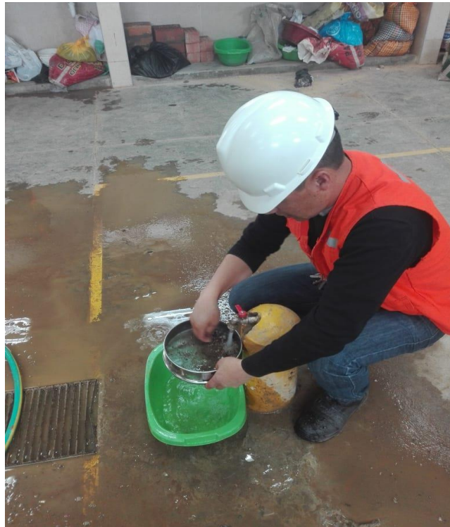
Figura 31 Lavado del material por la Malla 200.
