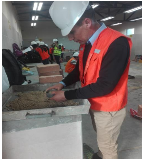
Figura 23 Colocación de la Muestra a la Tara.
