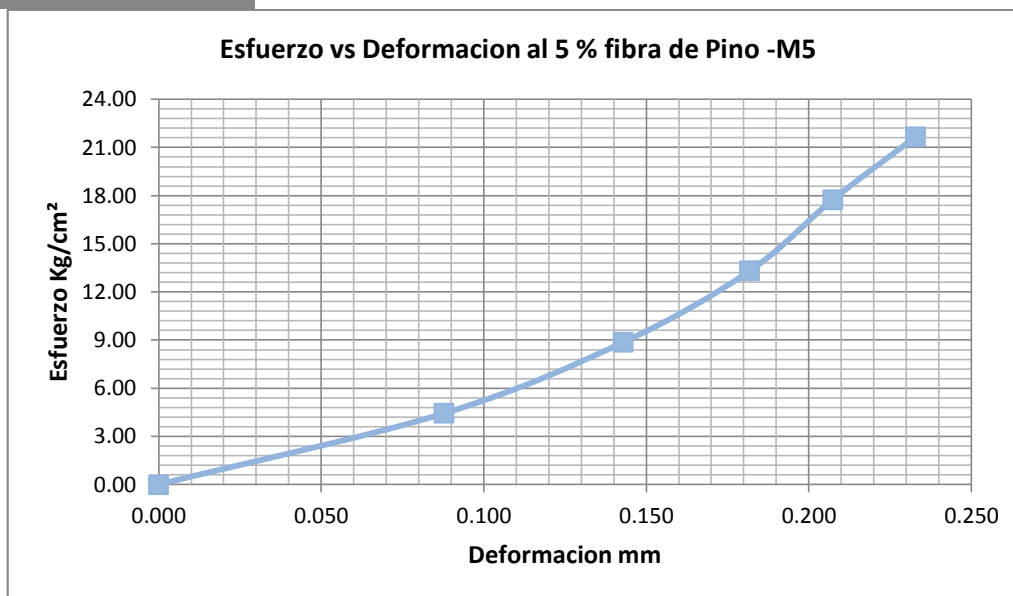
Gráfico 52 Determinación curva esfuerzo vs deformación M5 al 5 % con Fibra de Pino
