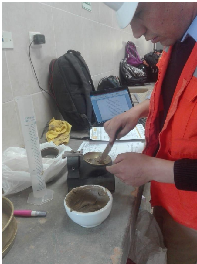
Figura 26 Colocación de Material al Instrumento Casagrande.
