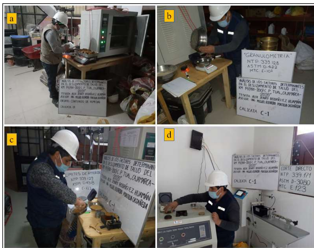
Figura 16. Ensayos del material extraído de la calicata C-1.
