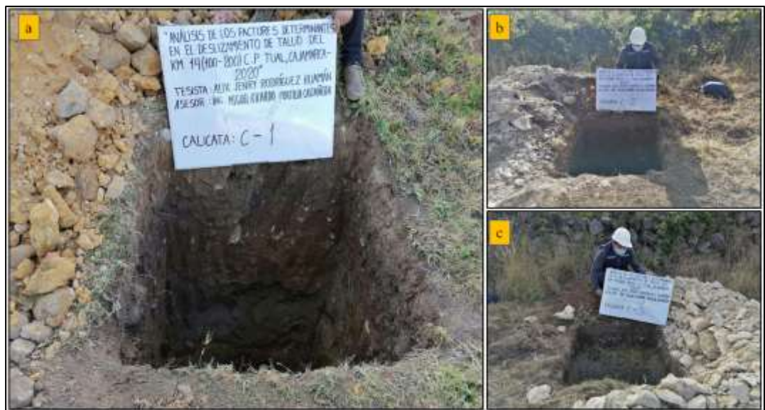
Figura 4. Apertura de las 03 calicatas.
