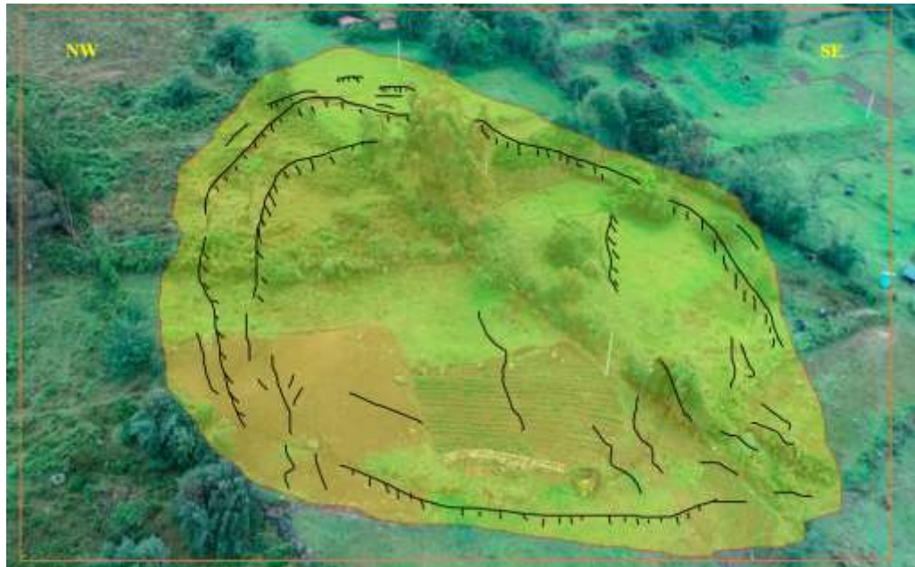
Figura 15. Deslizamiento de tipo rotacional.
