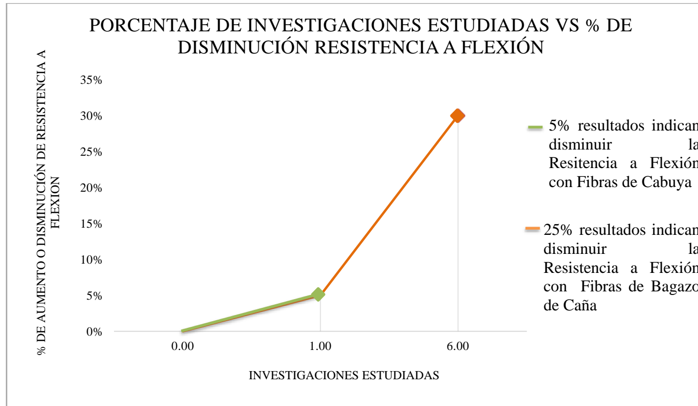
Figura 30: Comparación de las Investigaciones sobre el Aumento de Resistencia a Flexión del Concreto con Fibras
