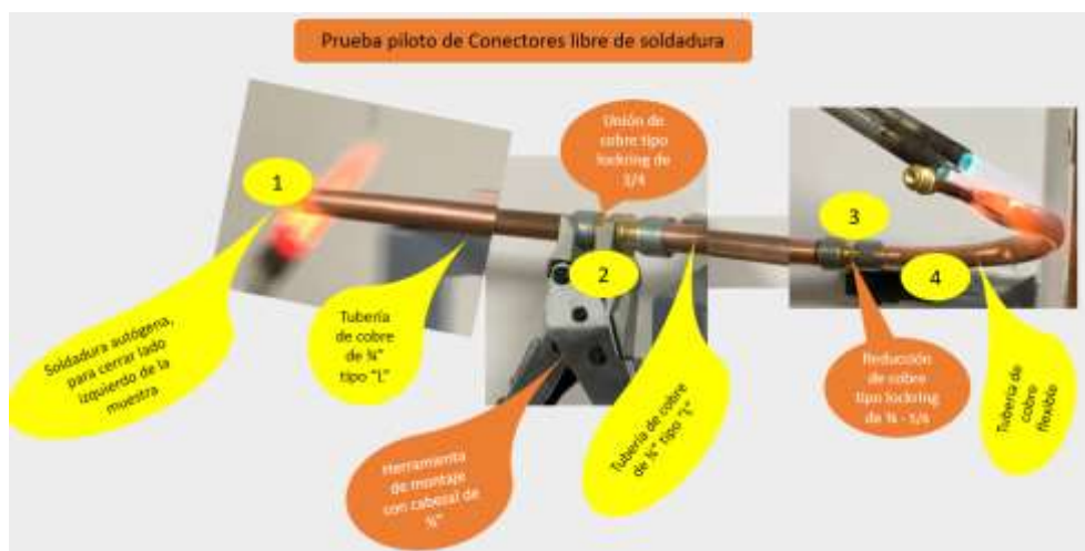
Figura N° 19. Prueba piloto - Test de presiones conectores libres de soldadura.
