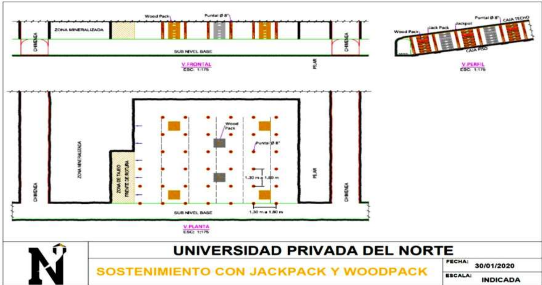
Figura 15: Sostenimiento con Jack pack y Wood pack - Detalle de instalación en un tajo Long Wall
