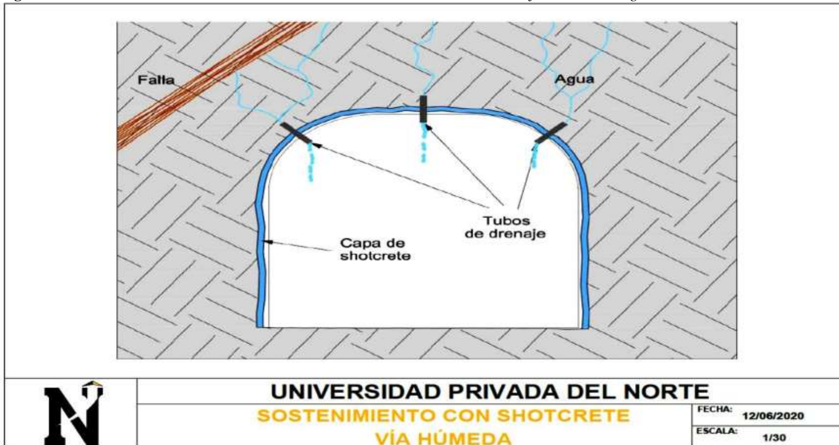
Figura 46: Sostenimiento con Shotcrete vía húmeda - Instalación de tubos de drenaje en zonas de agua
