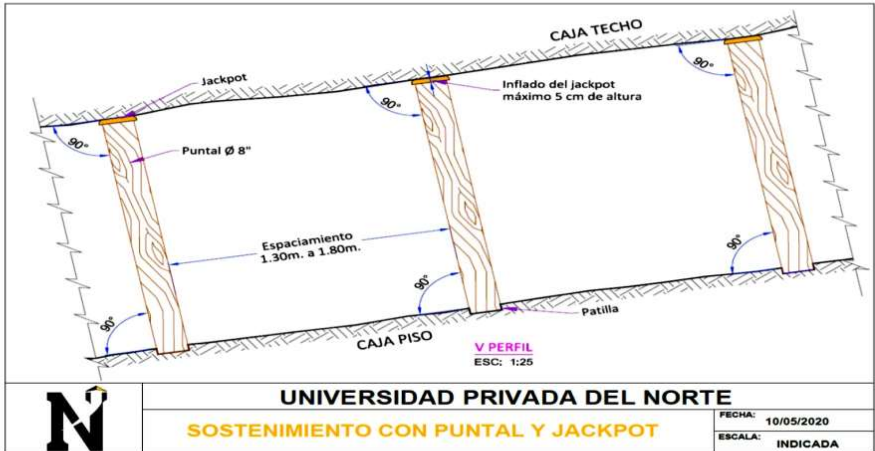
Figura 9: Sostenimiento con puntal y jackpot en el tajo - Instalación del puntal y jackpot
