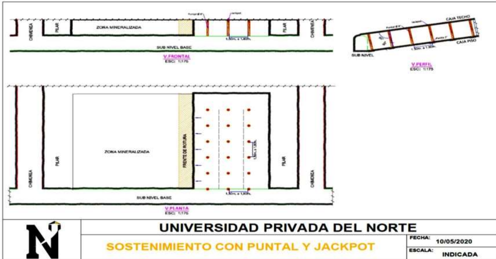
Figura 10: Sostenimiento con puntal y jackpot en el tajo - Distribución de espaciamiento entre puntales
