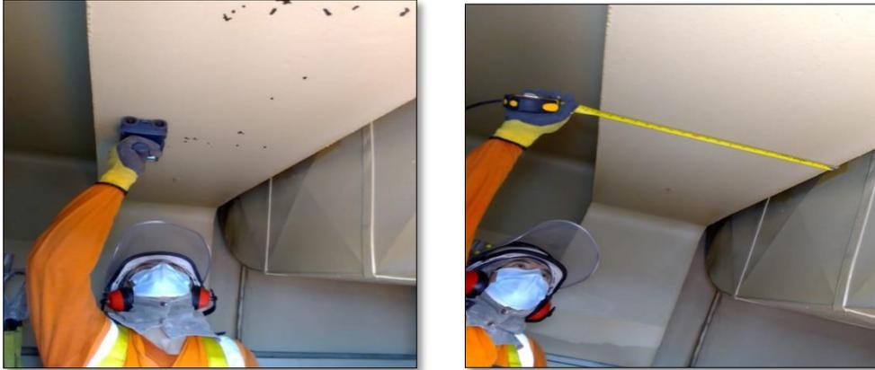
El número de varillas de refuerzo inferior encontrados en la viga V-06 inspeccionada es de 05 unidades.
