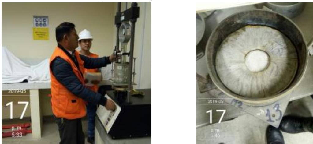
*Figura 14. Ensayo de Proctor Modificado con suelo-cemento (Método A)*
