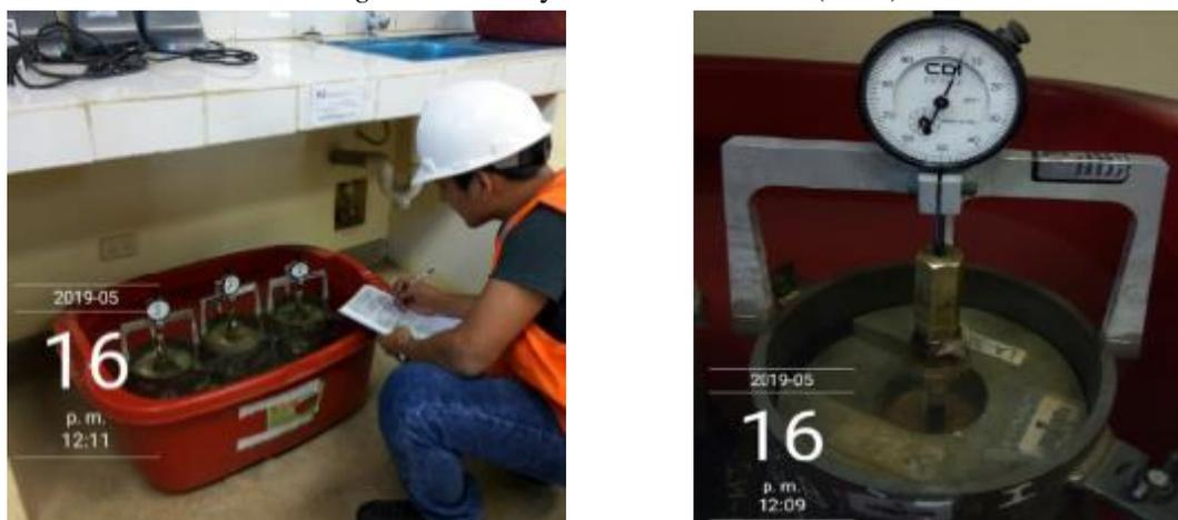
*Figura 13. Ensayo de Penetración (CBR)*
