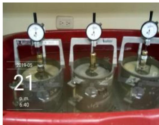
*Figura 16. Ensayo de Penetración suelo-cemento (CBR) con presencia del Asesor.*
