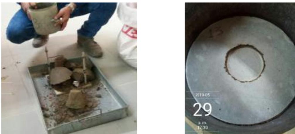
Figura 19. Ensayo de Penetración suelo-cemento (CBR).
