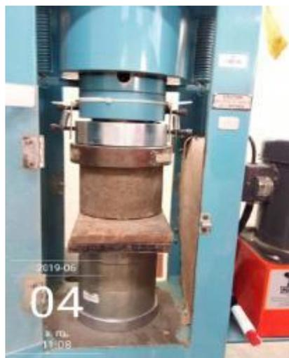
Figura 24. Ensayo de compresión simple 3.
