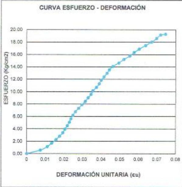
El gráfico muestra la curva esfuerzo-deformación con el eje vertical etiquetado como 'ESFUERZO (kg/cm<sup>2</sup>)' y el eje horizontal como 'DEFORMACIÓN UNITARIA (εu)'. La curva comienza en el origen (0,0) y muestra un comportamiento elástico lineal hasta aproximadamente 19.25 kg/cm<sup>2</sup> de esfuerzo, correspondiente a una deformación unitaria de 0.075.
