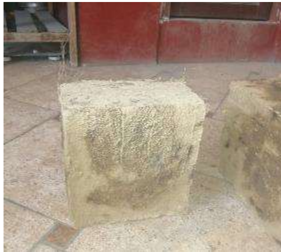
Figura 44. Unidad de adobe dividido en dos partes para ensayo de resistencia a la compresión
