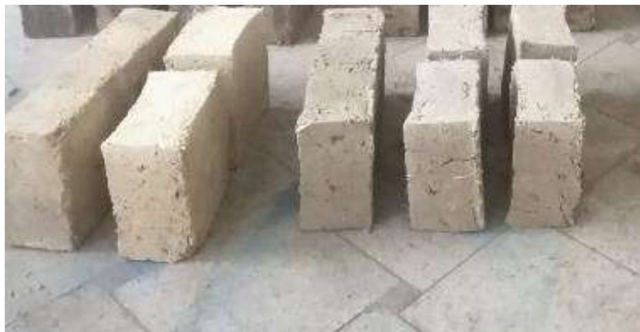
Figura 48. Enfriado de las unidades de adobe
