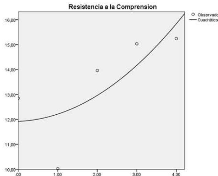
Figura 84. Prueba de resistencia a la compresión del adobe
