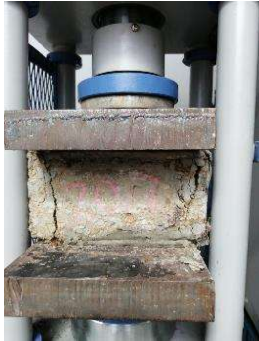
Figura 47. Ensayo de la resistencia a la compresión
