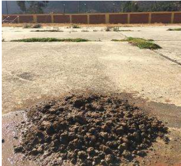
Figura 60. Tierra queda en reposo tras la humectación
