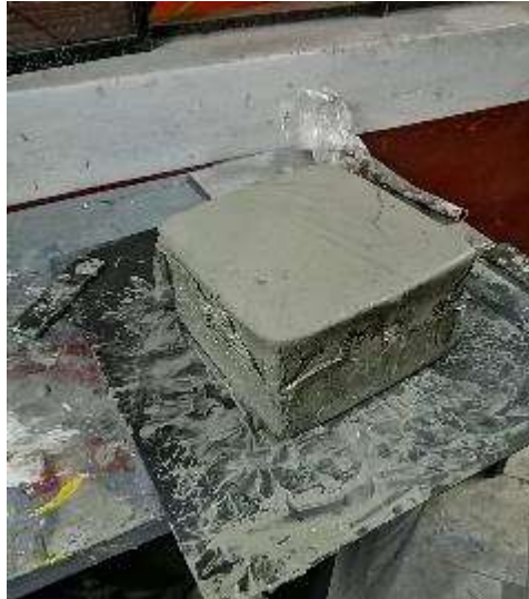
Figura 45. Refrentado del espécimen
