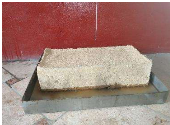
Figura 50. Especimen haciendo contacto con el agua
