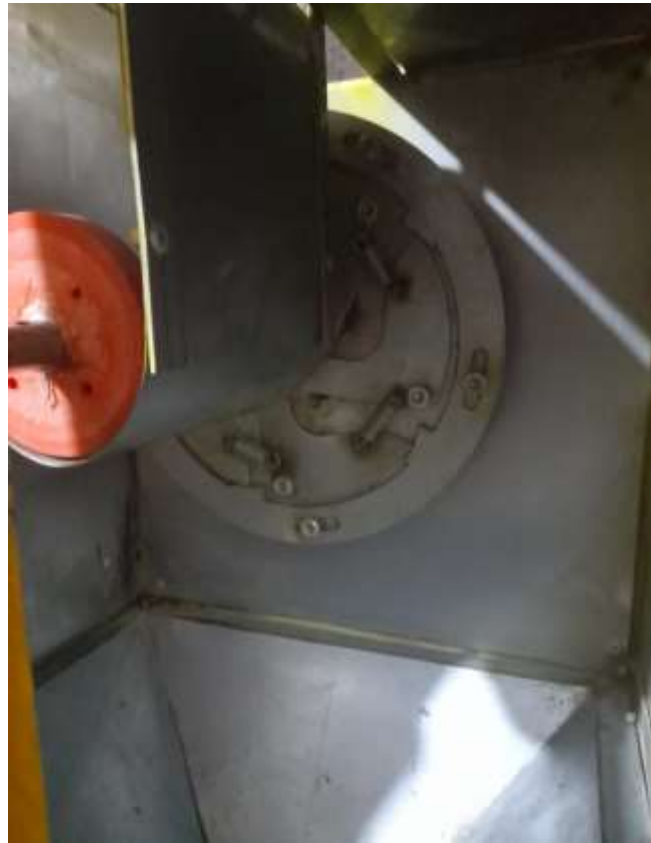
Figura 28. La zona de desgranado. En esta imagen se visualiza el disco desgranador y el ingreso del choclo para ser desgranado.
