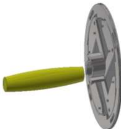
Figura 43. simulación del ingreso del choclo. El sistema de cuchillas se diseñó de en el inventor autodesk.
