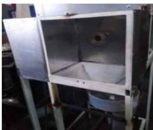
Figura 4. Forrado de la estructura. Es el recubrimiento de todas las paredes formadas por ángulos.
