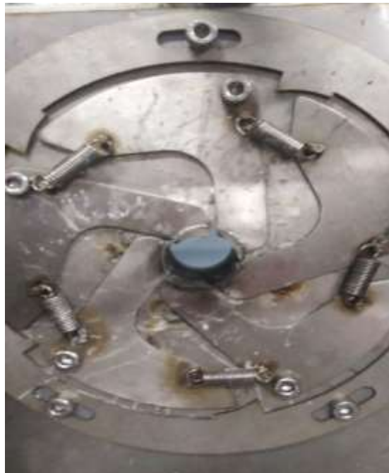
Figura 70. Análisis estructural del sistema de cuchillas. Se visualiza el punto de deformación o la zona más afectada.
