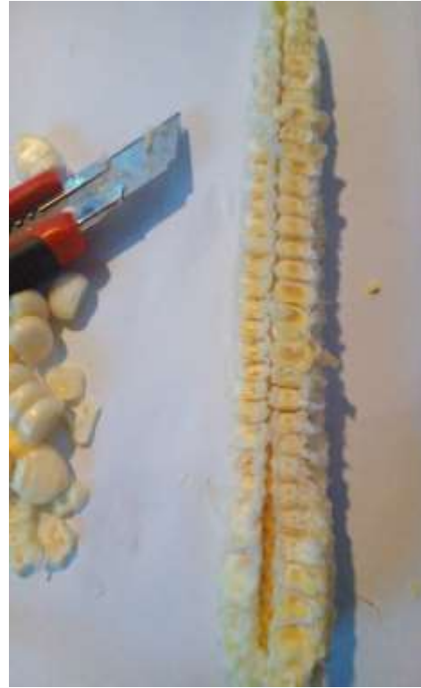
Figura 33. Choclo desgranado por cuchilla. A partir de esto se tomaron las medidas porque es lo que va a pasar por la abertura del disco desgranador.
