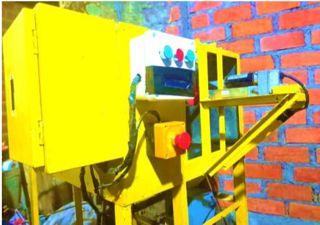
Figura 27. Estructura de la máquina. En esta imagen, se visualiza la ubicación del actuador final y la botonera y la parada de emergencia.
