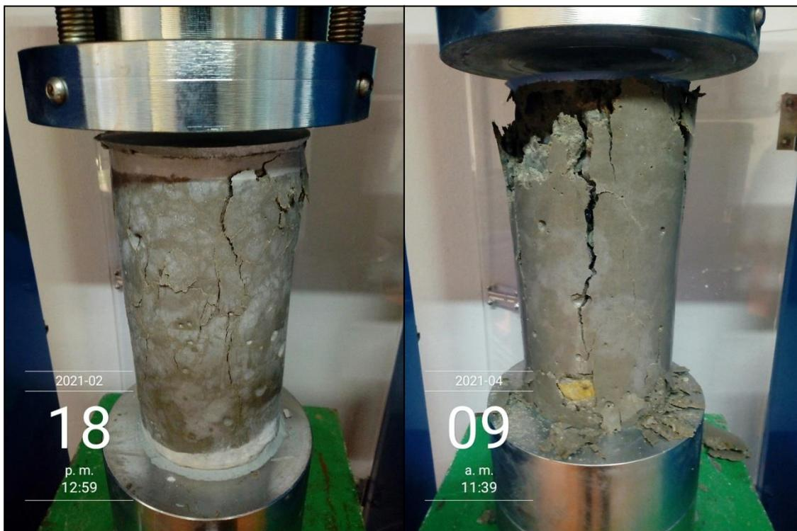
Fotografía 43. Tipo de falla del testigo. AC – 02.
