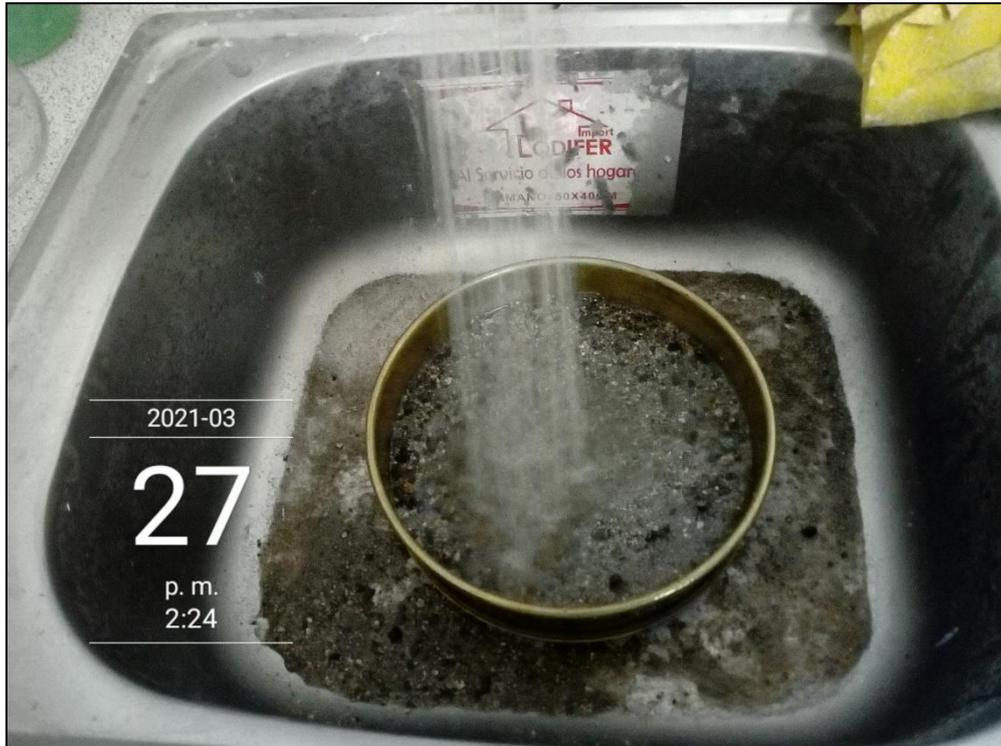
Fotografía 29. Peso específico del agregado fino, lavado por la malla #200. Tanda 3.
