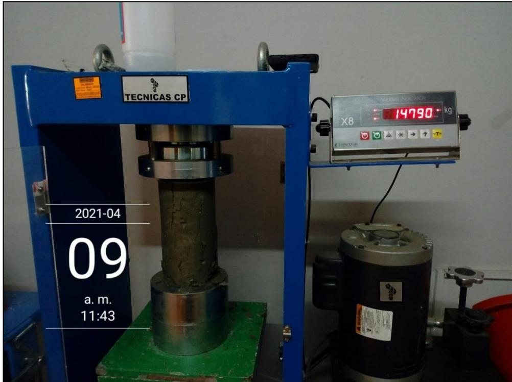
Fotografía 41. Rotura de testigos de concreto a la edad de 28 días. AC – 09.
