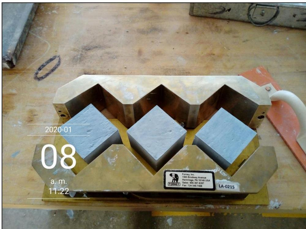
Fotografía 01. Calificación del material refrentante, moldeado de los cubos.
