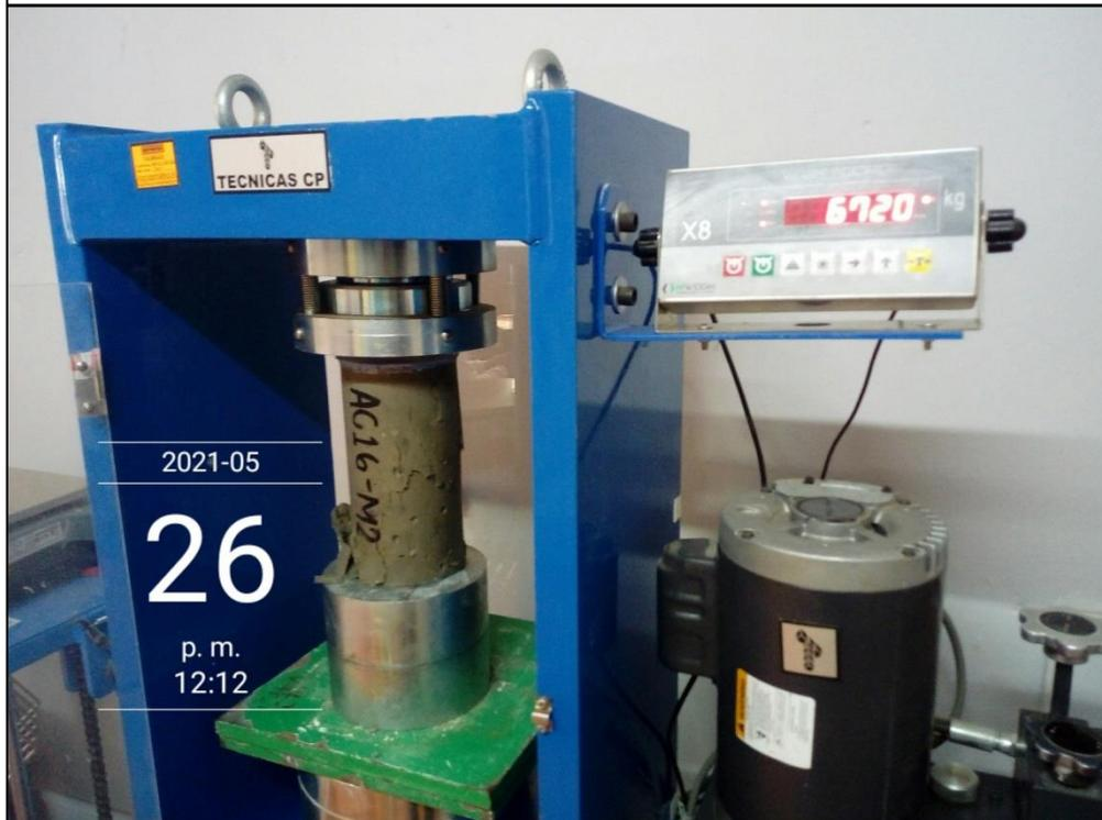
Fotografía 42. Rotura de testigos de concreto a la edad de 28 días. AC – 16.
