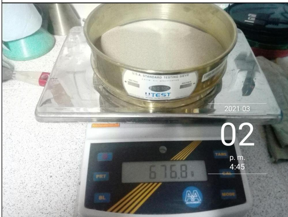
Fotografía 28. Granulometría del agregado fino, retenido en la malla #100. Tanda 2.
