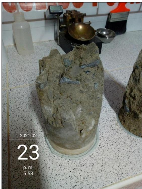
Fotografía 47. Composición del testigo. AC – 03.
