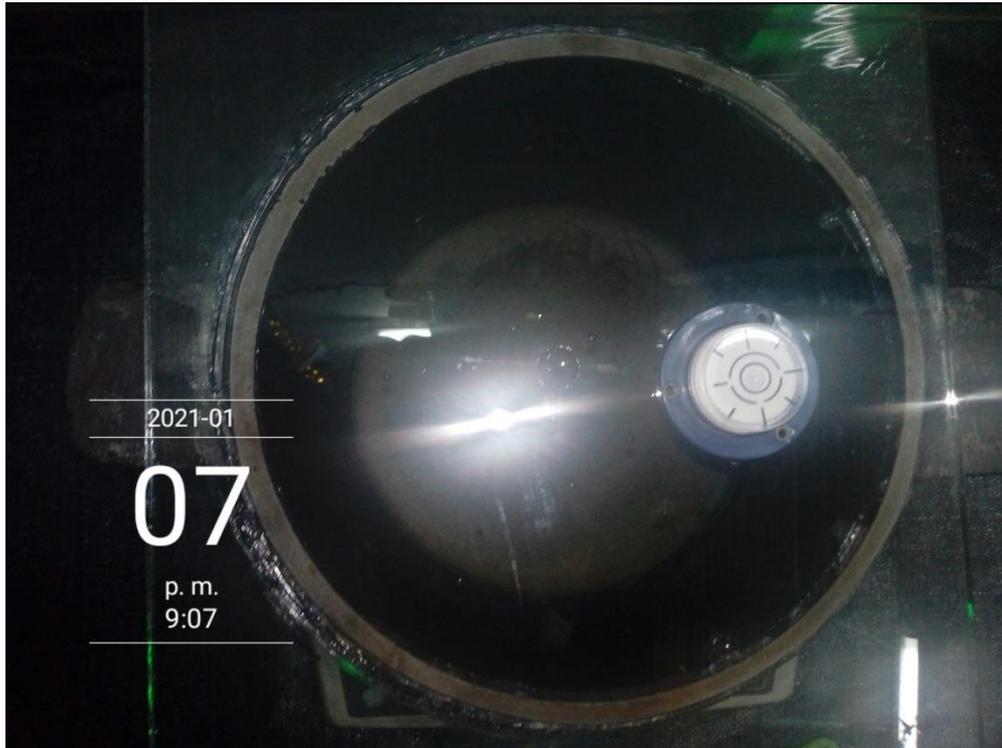
Fotografía 07. Cálculo del volumen de la olla de peso unitario, olla y balanza a nivel.
