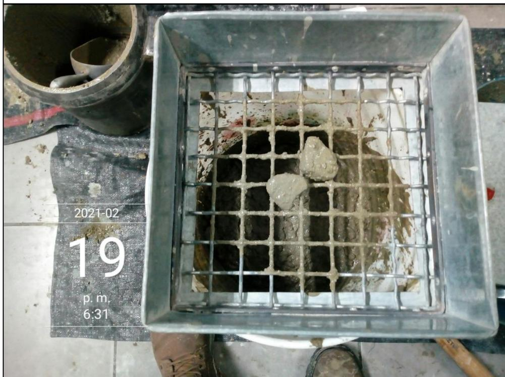
Fotografía 20. Tamizaje de la muestra de concreto por la malla 1 pulgada para elaborar los testigos de 20 x 10 centímetros. AC – 14.
