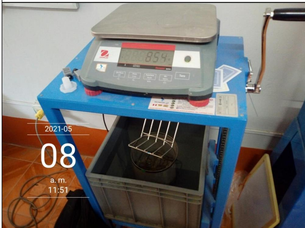
Fotografía 32. Peso específico del agregado grueso, peso sumergido del agregado. Tanda 4.
