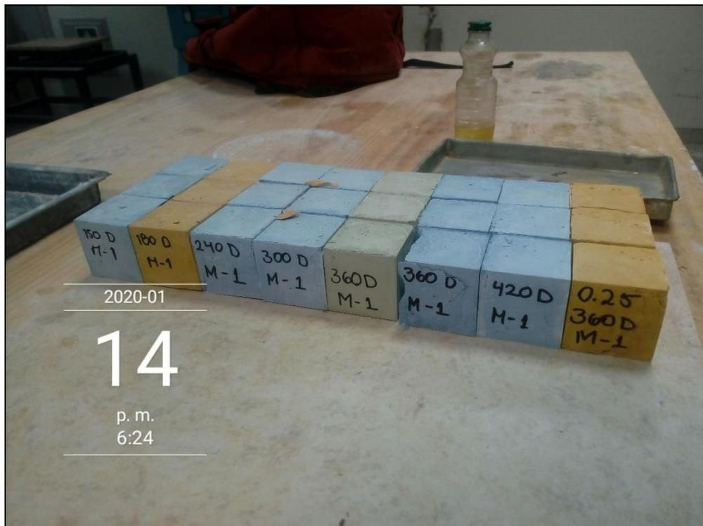
Fotografía 05. Calificación del material refrentante, totalidad de cubos ensayados.
