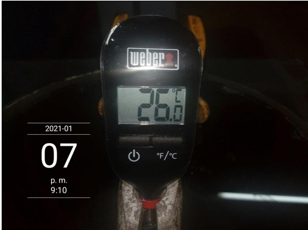
Fotografía 09. Cálculo del volumen de la olla de peso unitario, temperatura del agua.
