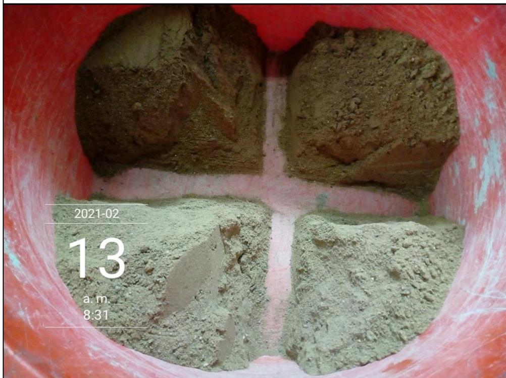
Fotografía 24. Reducción de muestra de los agregados por cuarteo. Tanda 1.
