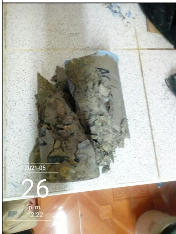
Fotografía 49. Composición del testigo. AC – 15.
