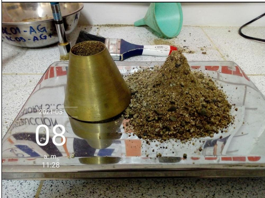
Fotografía 30. Peso específico del agregado fino, prueba del agregado S.S.S. Tanda 4.
