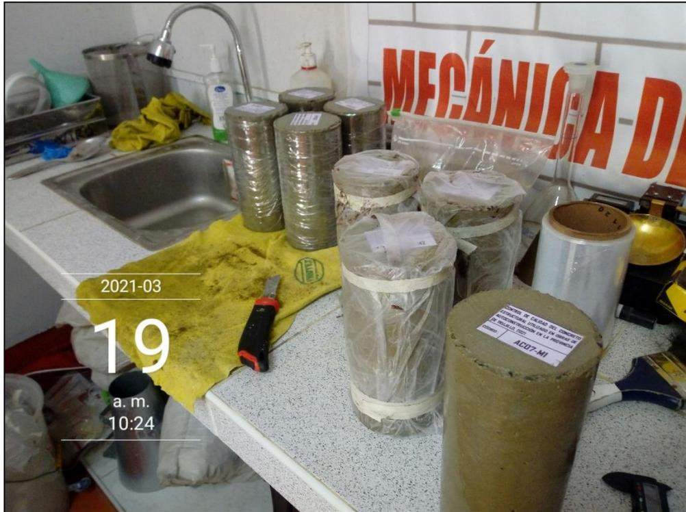
Fotografía 35. Protección ante pérdida de humedad en el transporte y en laboratorio.
