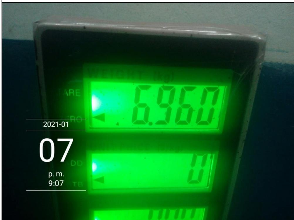
Fotografía 08. Cálculo del volumen de la olla de peso unitario, peso del agua destilada.
