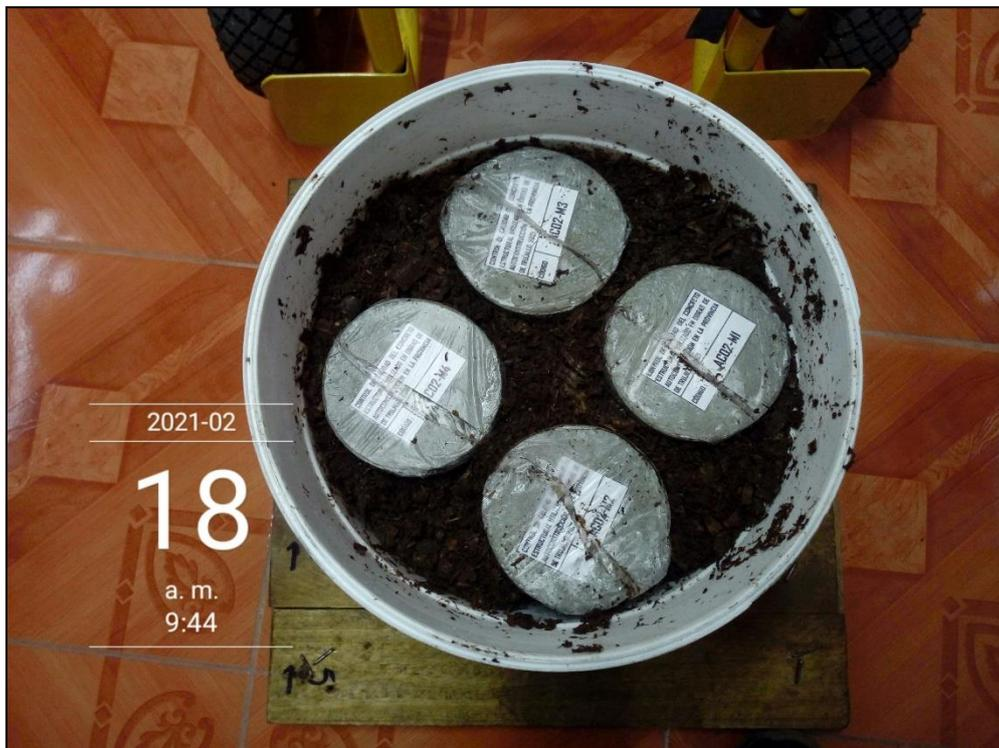
Fotografía 33. Transporte de los testigos al laboratorio, sobre aserrín. AC – 02.
