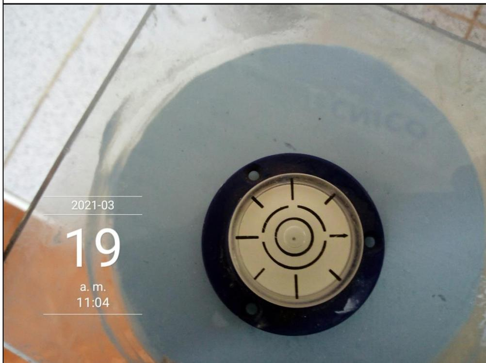
Fotografía 36. Capping de testigos de concreto, yeso perfectamente nivelado. AC – 07.
