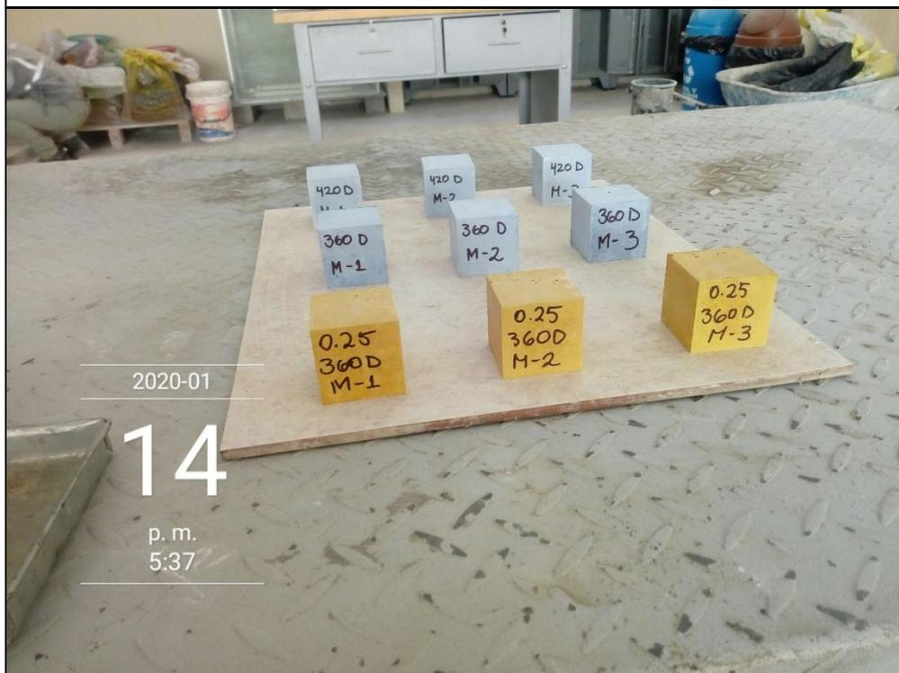
Fotografía 02. Calificación del material refrentante, curado de los cubos.
