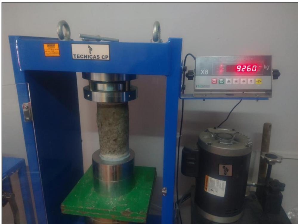
Fotografía 39. Rotura de testigos de concreto a la edad de 28 días. AC – 01.
