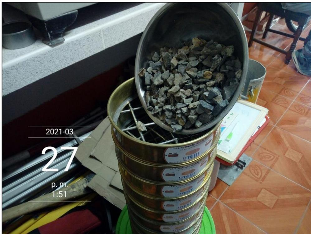
Fotografía 27. Granulometría del agregado grueso, tamizaje del agregado grueso. Tanda 3.
