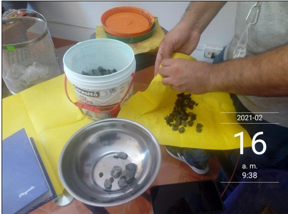
Fotografía 31. Peso específico del agregado grueso, secado del agregado. Tanda 1.
