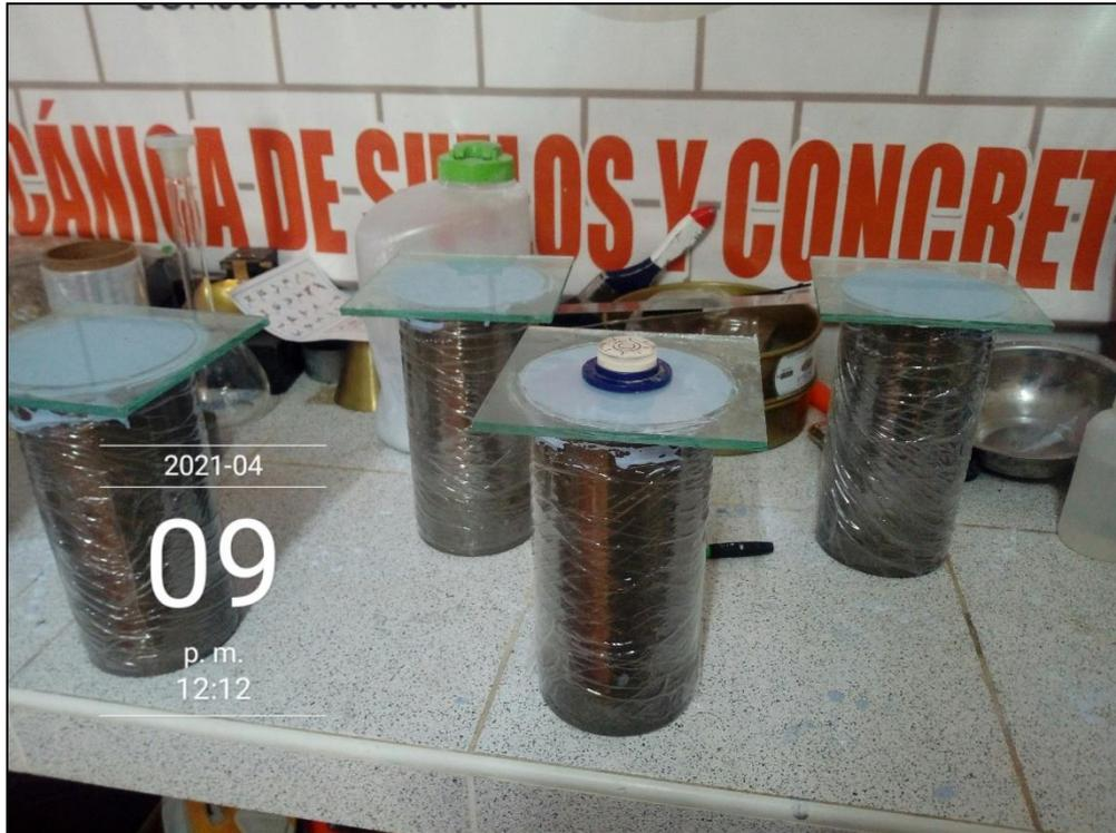
Fotografía 37. Capping de todos los testigos a ser ensayados. AC – 10.
