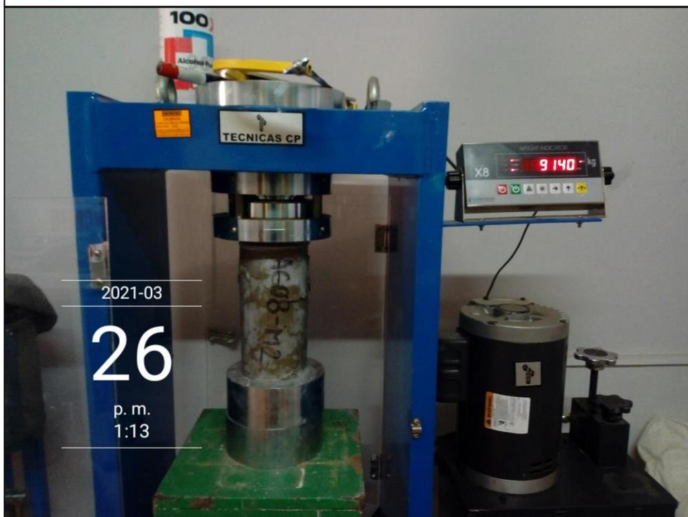
Fotografía 40. Rotura de testigos de concreto a la edad de 28 días. AC – 08.
