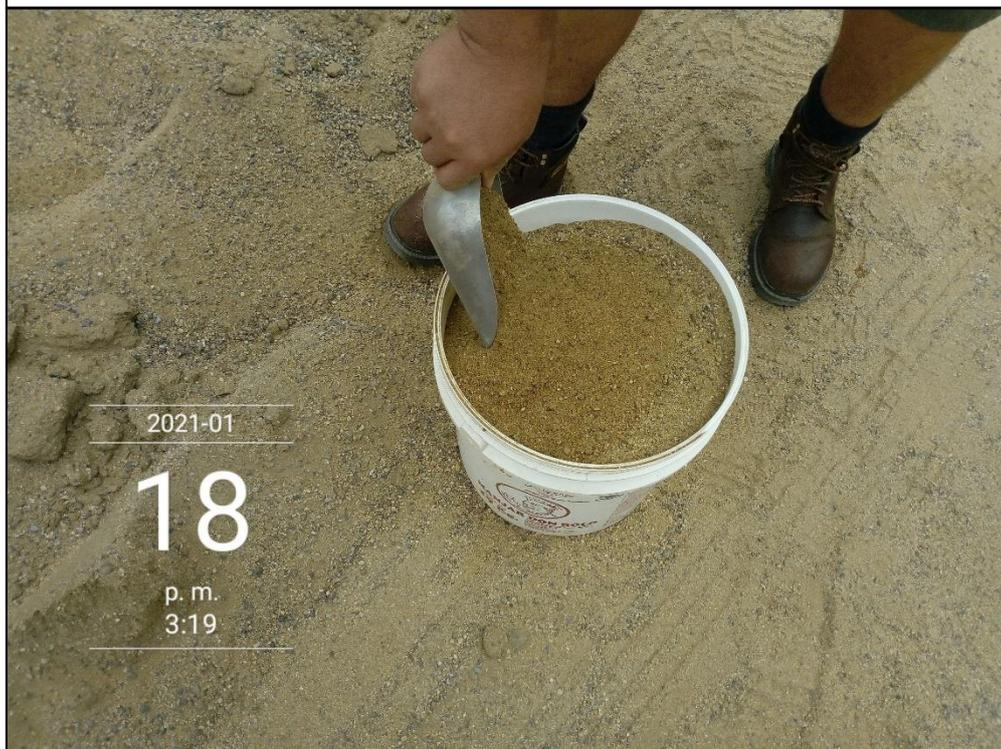
Fotografía 18. Toma de muestra (18 L) del agregado fino. AC – 01.
