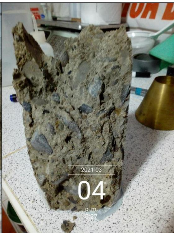
Fotografía 48. Composición del testigo. AC – 04.
