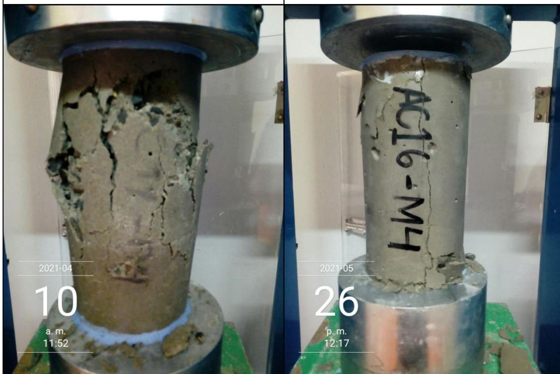
Fotografía 45. Tipo de falla del testigo. AC – 11.
