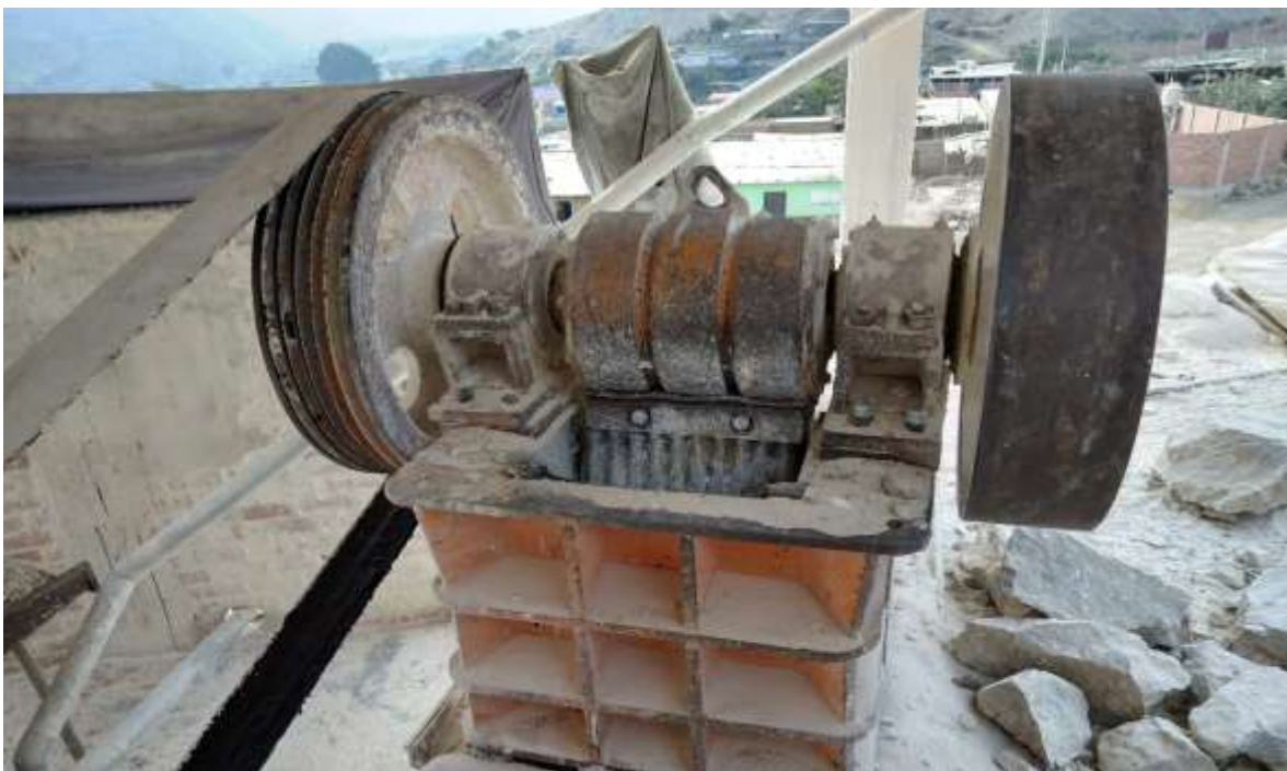
Foto 14. Máquina chancadora sin guarda de seguridad en cantera Cal y Yeso S.A.C.
