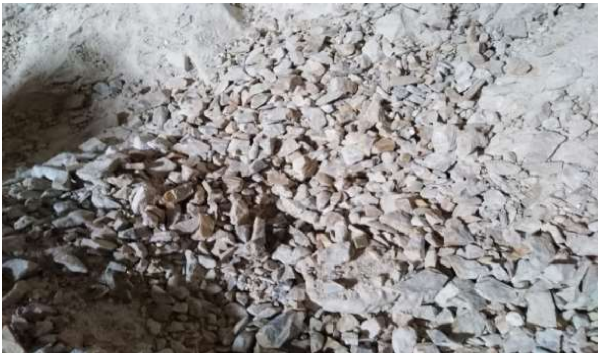
Foto 6. Roca muy fragmentada después de la voladura que será recogida en sacos.
