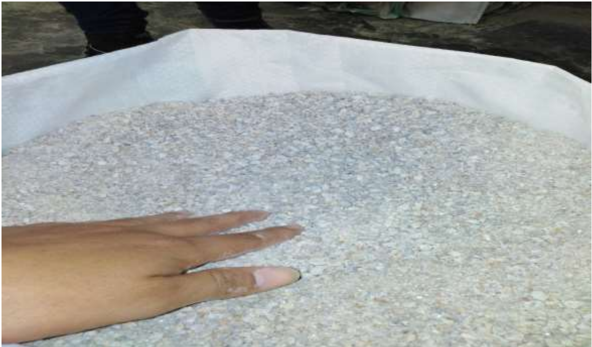
Foto 11. Caliza con dimensiones de 1 a 2 pulgadas luego de pasar por el proceso de chancado.
