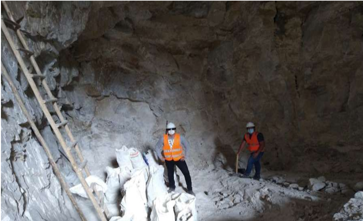
Foto 15. Interior de la cantera donde se ve que solo hay sostenimiento natural.
