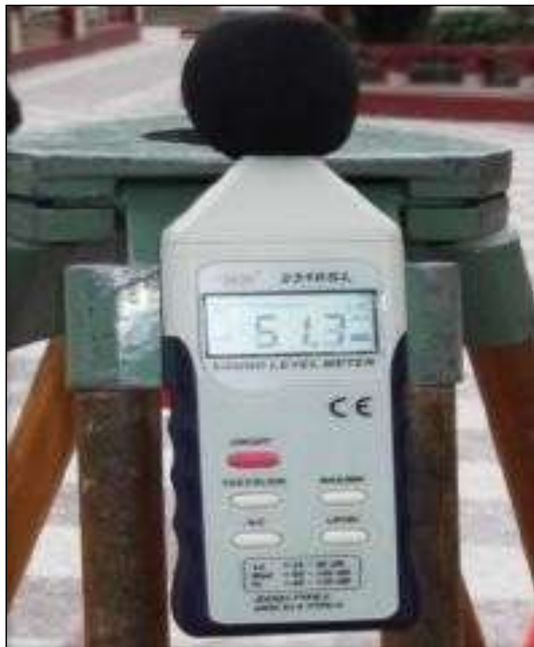
Figura 41. Sonómetro para medir niveles de ruido.
