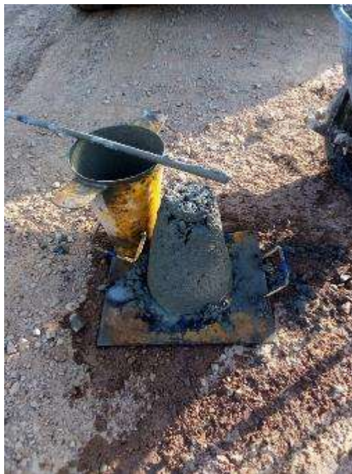
Figura 28. Verificación del Slump
