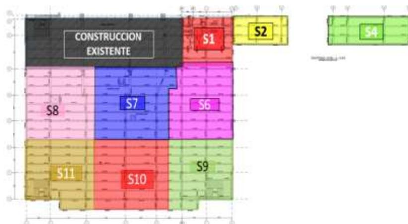
**Figura N°20:** Sectorización elementos horizontales – piso 2
