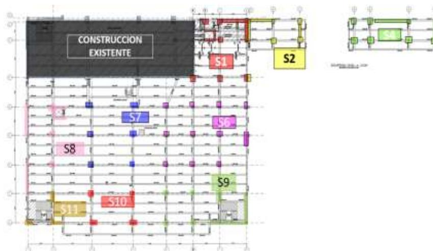
**Figura N°19:** Sectorización elementos verticales – piso 2
