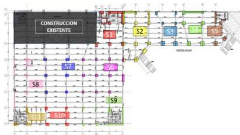
**Figura N°17:** Sectorización elementos verticales – piso 1
