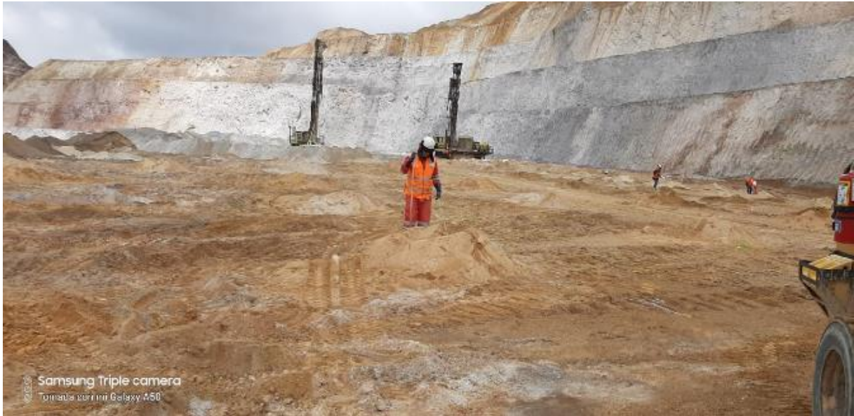
Foto 1: Perforación de los taladros de producción con la perforadora Pit Viper.
