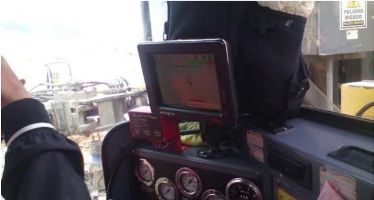
Foto 4: Posicionamiento incorrecto del taladro, pero con un margen aceptable.
