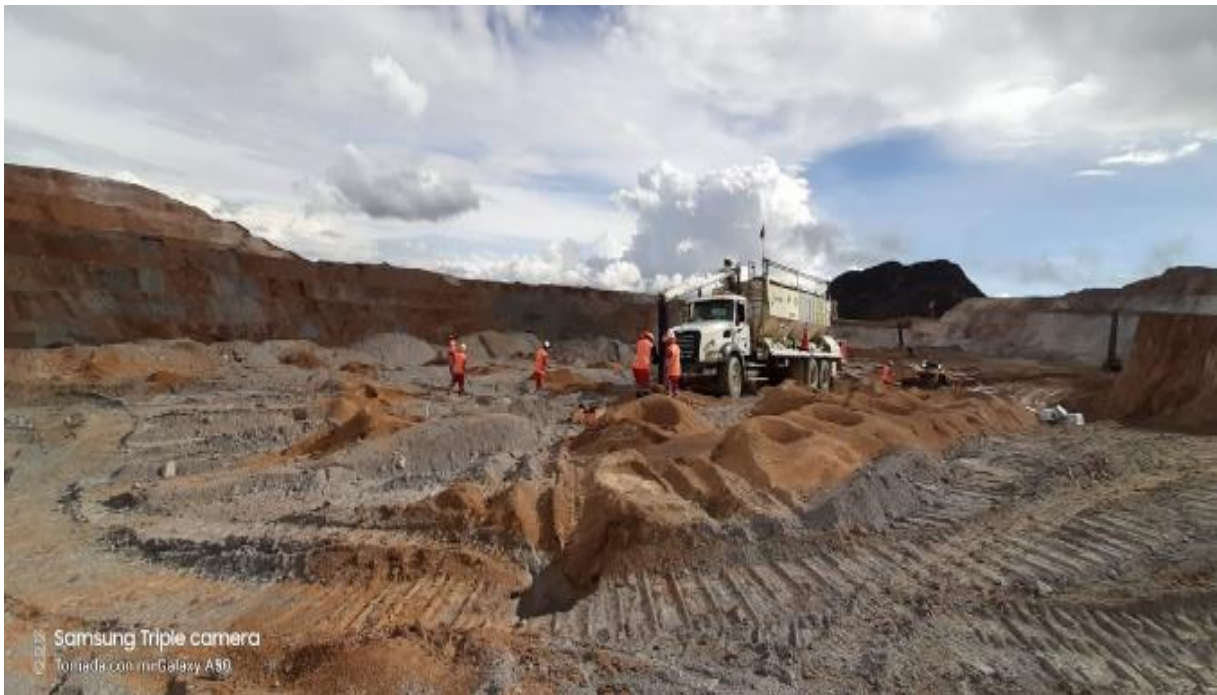
Foto 2: Alineamiento de los taladros de producción.
