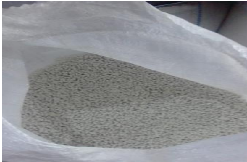
Figura 9. Muestra de PEHD Muestra realizada en la empresa MAFARED S.A.C, pellets de Alta densidad
