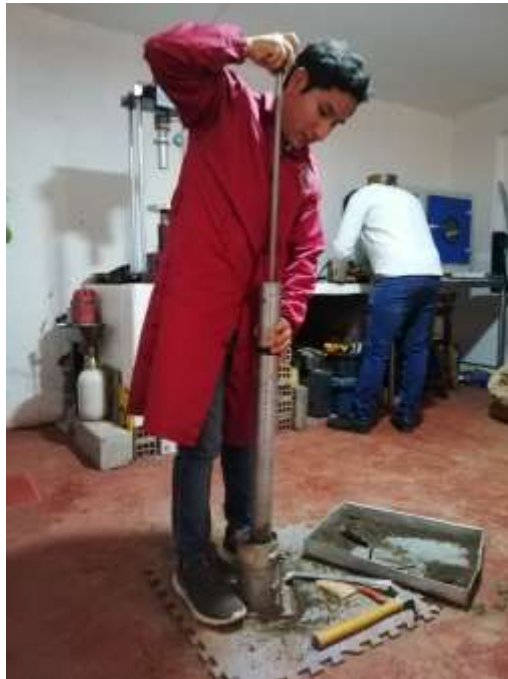
Figura 26 Ensayo Proctor Modificado, compactación
