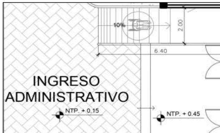
Figura.123. Planta primer nivel del proyecto-Rampa de ingreso.
