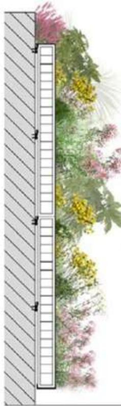
*Figura 5* Jardín vertical con sistema estructural suspendido
