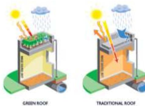
*Figura 15:* Función de techo verde contra la regulación de la temperatura
