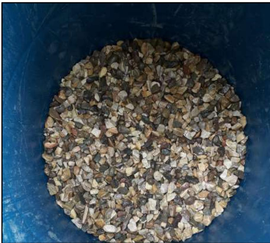
**Fotografía 7:** Colocación de segunda capa Filtro - Gravilla de 1/2"
